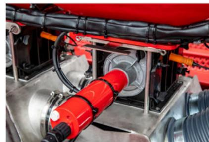
Doseur – système de trémie sous pression avec guillotine en place
