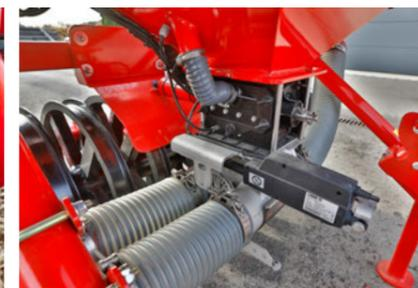
Grâce à une activation SectionControl, la coupure demi-semoir électrique peut être automatisée.
