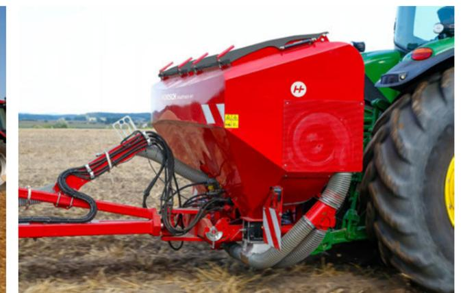
Trémie à double cuve d'un volume de 2 800 l
