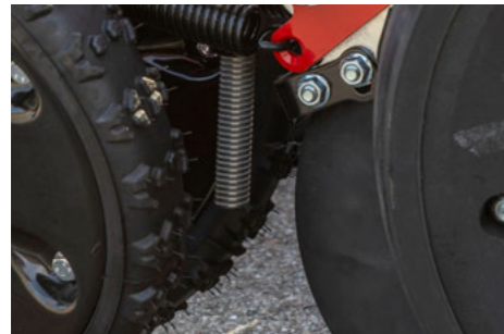
Incorporation d'engrais liquide derrière la roulette de plombage
