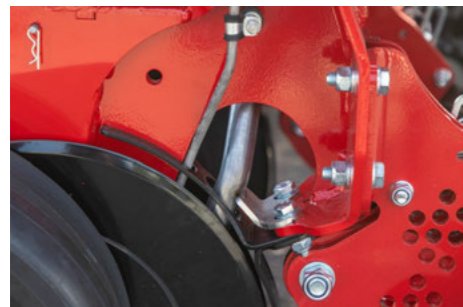
Incorporation d'engrais liquide dans le rang
