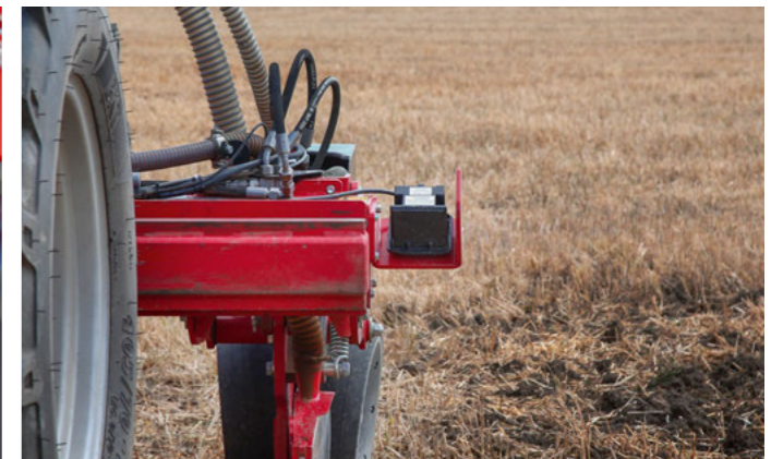
L'un des capteurs radars supplémentaires pour le ContourFarming
