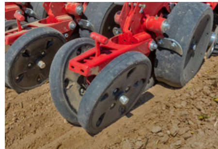
Roulette de fermeture large en V
