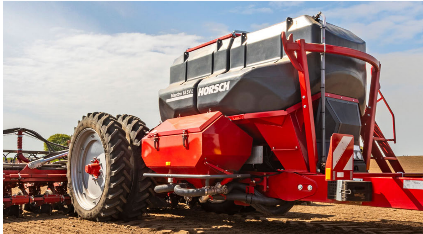
Microgranulateur Pour le remplissage et une meilleure accessibilité de la machine, la cuve peut être déplacée vers l'avant
