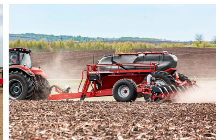
Report de charge de la remorque semoir vers la barre de semis pour une pression élevée jusqu'à 350 kg
