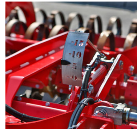
Réglage hydraulique de la profondeur de travail pour un maximum de confort d'utilisation
