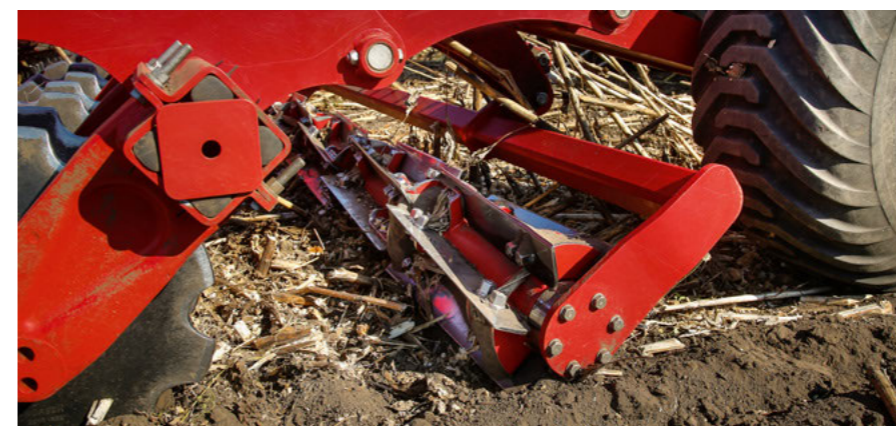
Rouleau couteaux en option, précontraint hydrauliquement pour un effet de broyage additionnel
