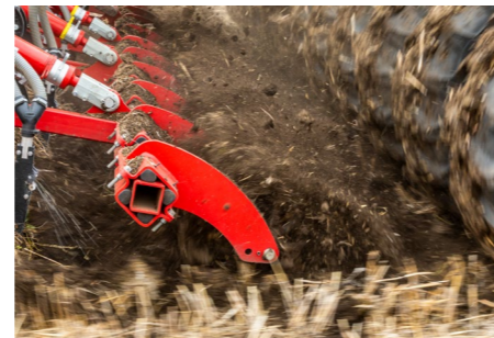
Production de terre fine avec le rouleau émietteur
