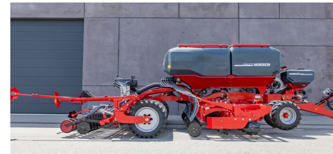
Packer à pneus de grande dimension pour un ré-appui en profondeur
