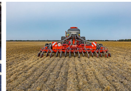
Sillon dénué de résidus grâce à la dent TurboEdge
