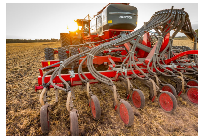
Élément semeur TurboEdge pour un sillon dénué de résidus
