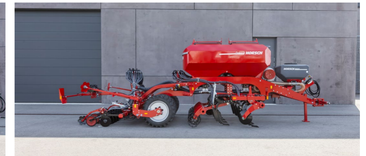
Packer à pneus de grande dimension pour un fonctionnement aisée
