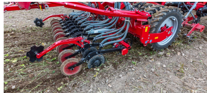
Focus 3 TD avec rampe de semis TurboDisc : Interrang de 30 cm
