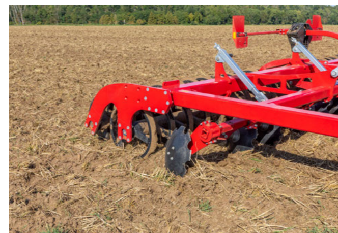
Excellent nivellement sous l'effet combiné des disques de nivellement et du double rouleau
