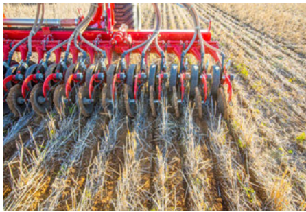
Bouleversement du sol limité grâce à l'élément semeur SingleDisc
