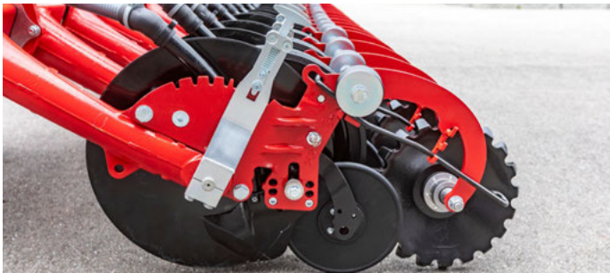
Grâce à son profil étoilé, la roulette de fermeture assure la production de terre fine et la fermeture du sillon.
