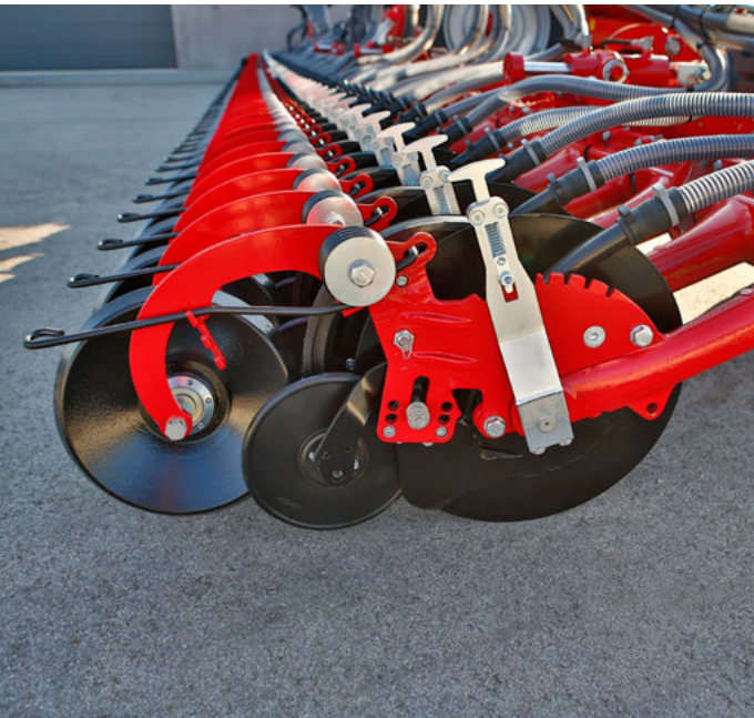
Rappui parfait de la graine au fond du sillon grâce à la roulette de plombage en caoutchouc
