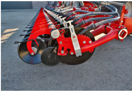
SingleDisc – Parfaite adaptation aux dénivellements du sol grâce à la roue de terrage
