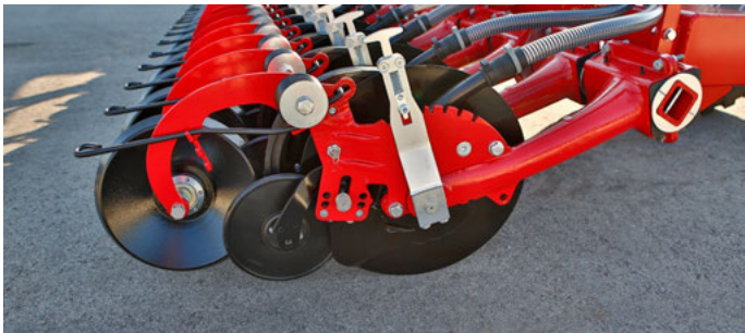
Roulette de fermeture lisse pour toutes les conditions
