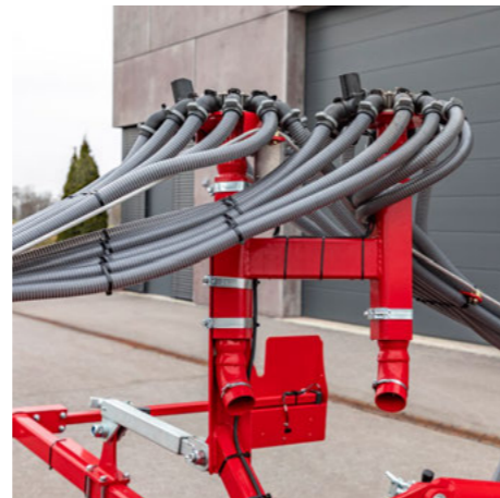
Вимкнення розподільчої башти і, таким чином, посів можливий кожним другим рядом
