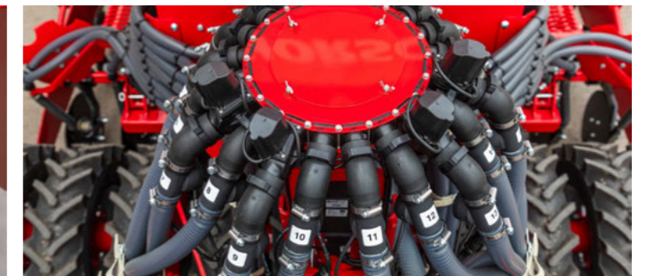
Сенсори потоку на розподільній башті
