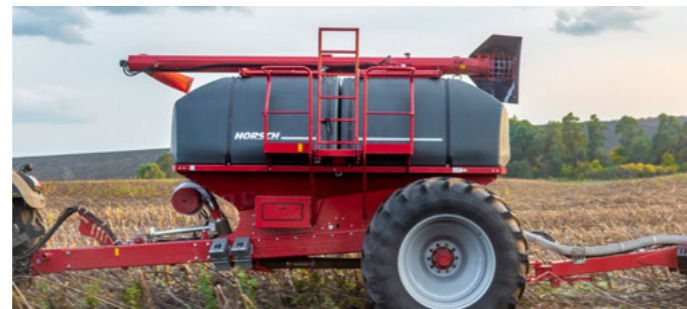
Гідравлічний шнек для автономного завантаження
