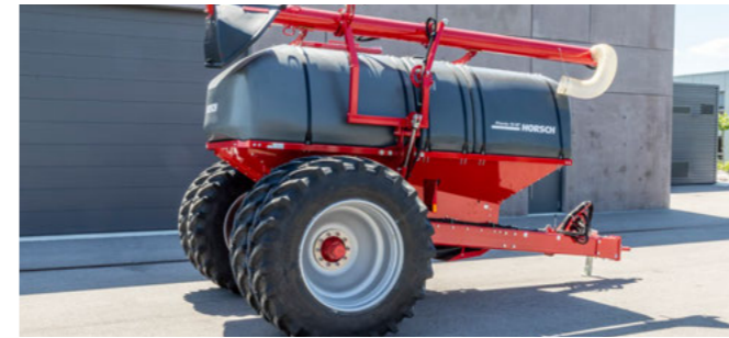
Гідравлічний шнек для автономного завантаження
