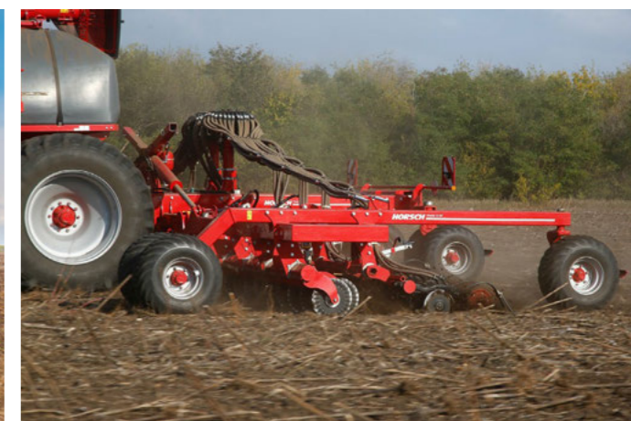
Розпушування поверхні та достатнє подрібнення ґрунту для оптимального загортання насіння
