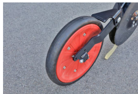
Прикочувальні колеса шириною 5 см ідеально підходять для середніх і важких ґрунтів
