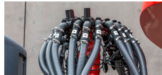
Контроль потоку насіння й добрив — для безперервного стеження за насіннє- й тукопроводами
