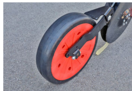
Прикочувальні колеса шириною 7 см ідеально підходять для легких ґрунтів
