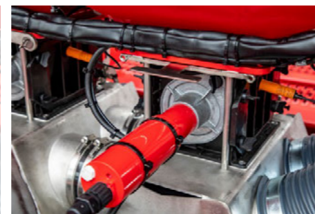
Дозатор — напірний бункер із вставленою запірною заслінкою
