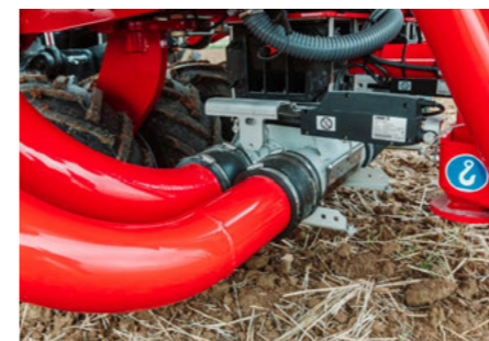
Електричне відключення внесення матеріалу на половину ширини захвату - просте керування одним натиском кнопки на терміналі.
