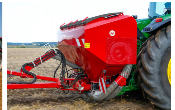
Двосекційний бункер об'ємом 2800 л
