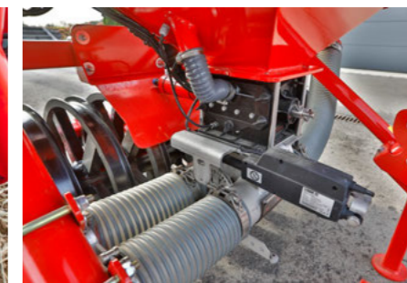
З функцією SectionControl електричне відключення внесення матеріалу на половину ширини захвату відбувається в автоматичному режимі.
