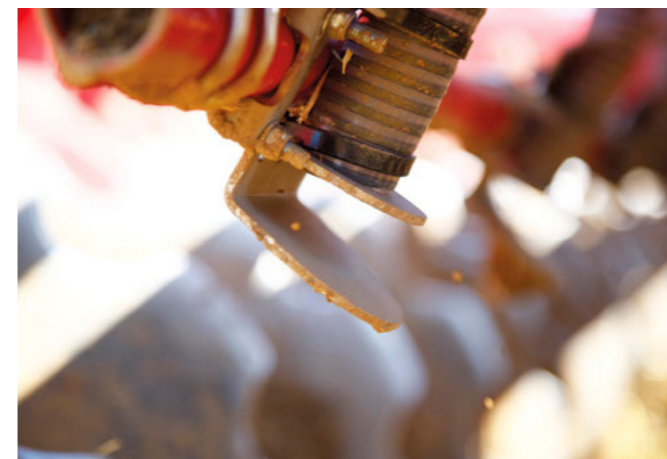
Розсівні пластини для рівномірного розподілення матеріалу
