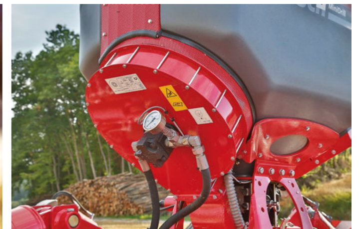
Оснащене автономним компресором
