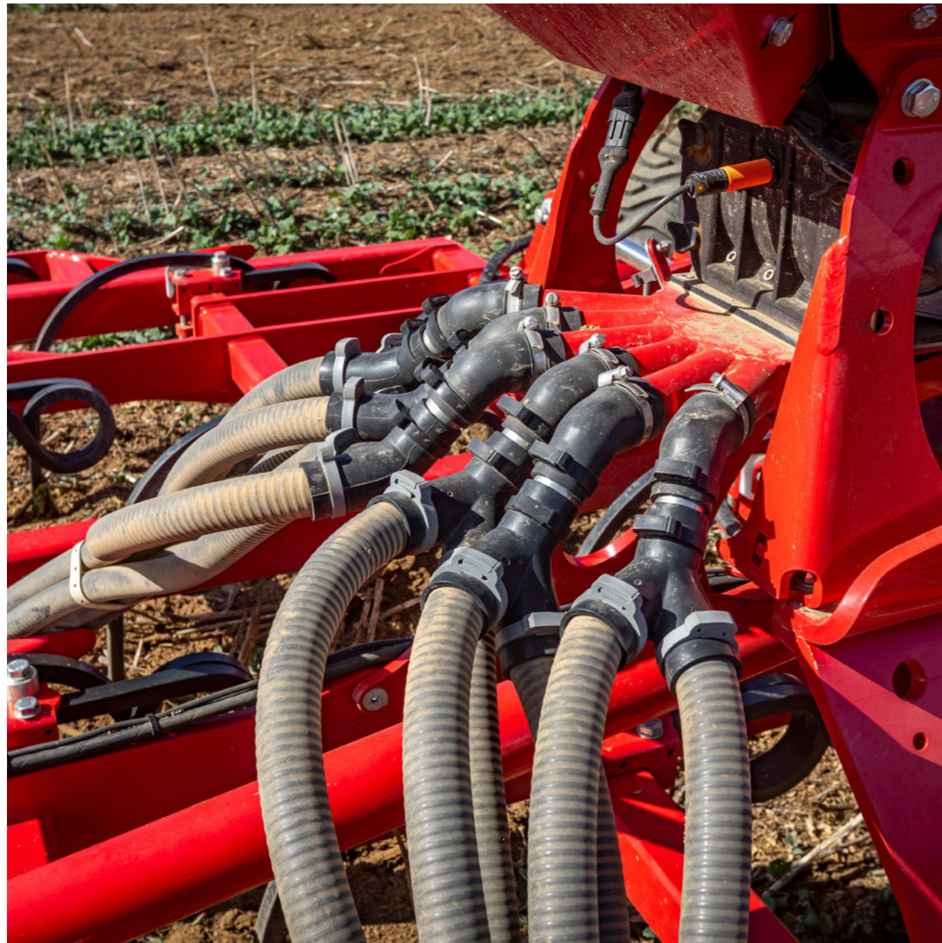
Варіативна кількість виходів або розподільних башт
