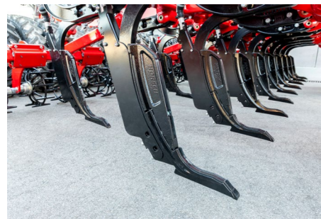
Лапа ULD розпушує ґрунт, не перемішуючи його
