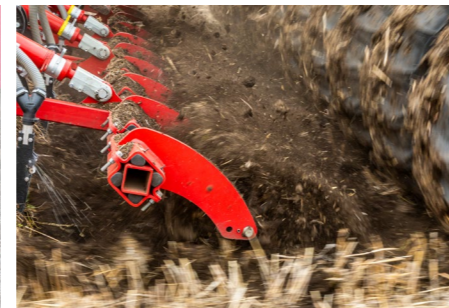
Подрібнення грудок спеціальними робочими органами (грудобоями)
