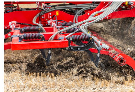
Лапи LD/LD Plus — перемішування спущеного ґрунту
