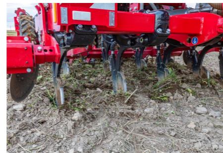
Лапа ULD відкриває рядок й вносить добрива
