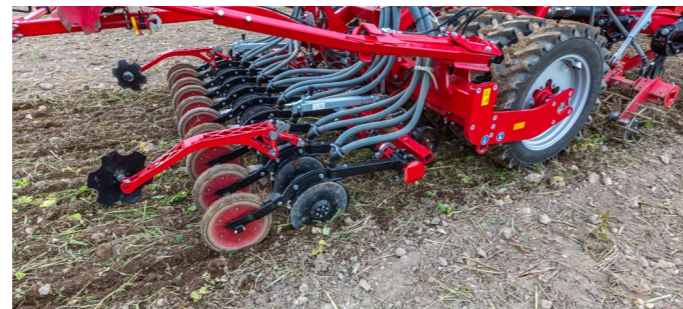
Focus 3 TD з висівною шиною TurboDisc з міжряддям 30 см
