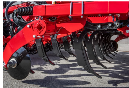
Лапи LD/LD Plus з помітним ефектом перемішування
