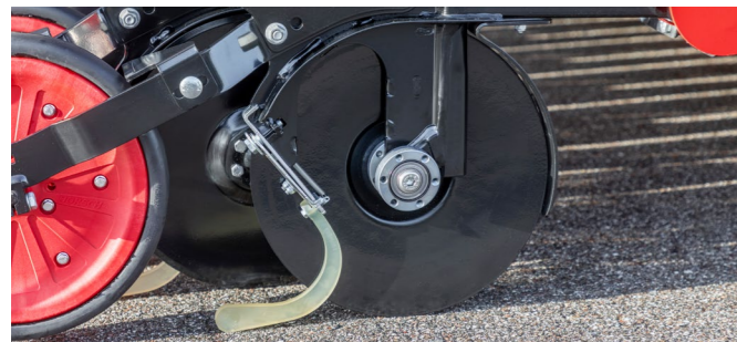
Розташування насінневої трубки перед підшипниковим вузлом і рухливий внутрішній чистик запобігають блокуванню сошників під час посіву у вологий ґрунт
