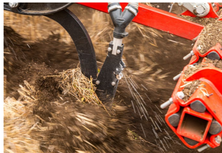
Лапи LD/LD Plus — внесення добрив у верхній шар ґрунту
