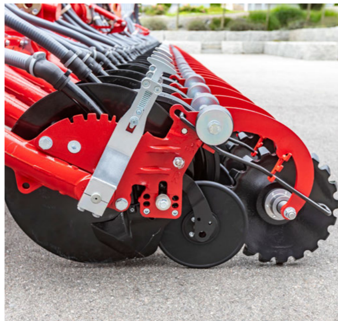
Сталеві загортачі з шипами добре подрібнюють ґрунт і закривають посівну борозну
