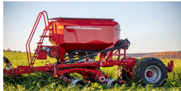
Дво- або трисекційний бункер об'ємом 3800 л
