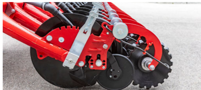
Зубчаті прикочувальні колеса добре подрібнюють ґрунт і закривають посівну борозну
