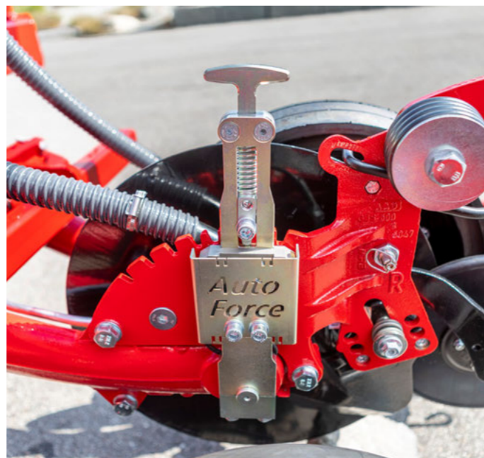
AutoForce для забезпечення рівномірних дружних сходів
