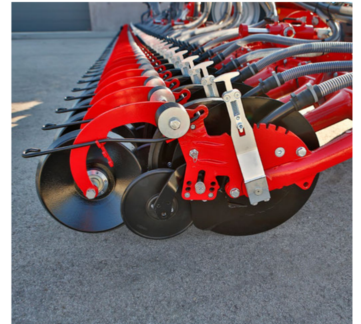
Ідеальна фіксація насінин завдяки гумовим вловлювальним колесам
