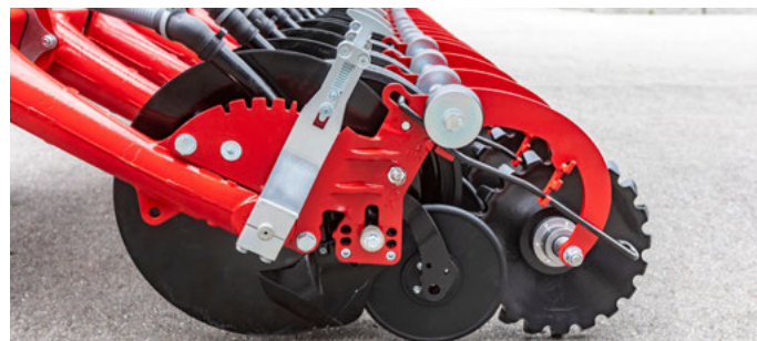
Сталеві загортачі з шипами добре подрібнюють ґрунт і закривають посівну борозну
