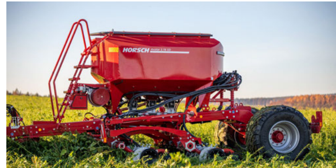
Дво- або трисекційний бункер об'ємом 3800 л
