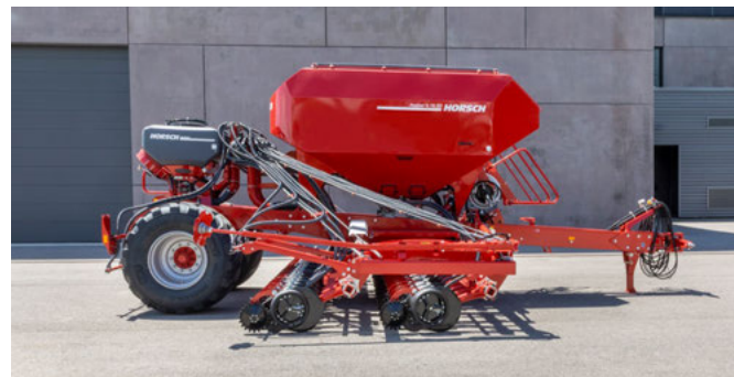
Двосекційний бункер об'ємом 5000 л
