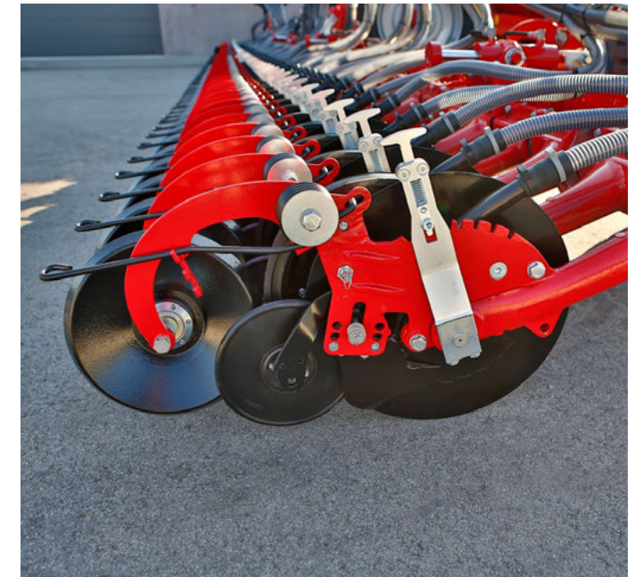
Ідеальна фіксація насінин завдяки гумовим вловлювальним колесам
