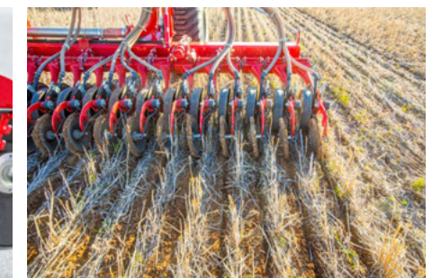
Сошники SingleDisc завдяки своїй особливій конструкції забезпечують лише мінімальне втручання в ґрунт
