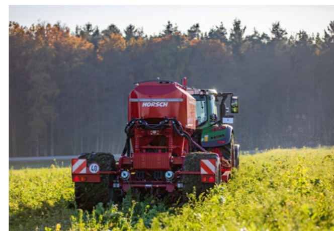
Avatar 3.16 SD проводить сівбу напряду в покрив сидератів
