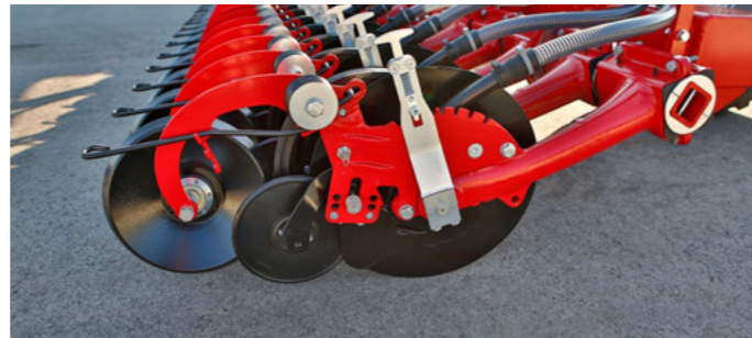
Гладкі сталеві прикочувальні колеса для будь-яких умов
