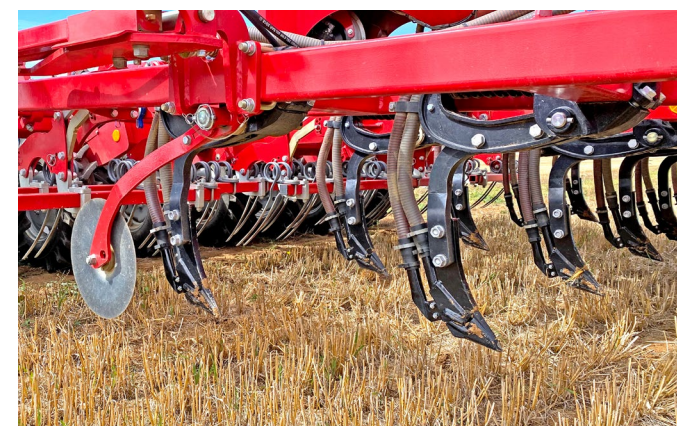
Minimale Bodenöffnung mit dem ThinEdge Schar
