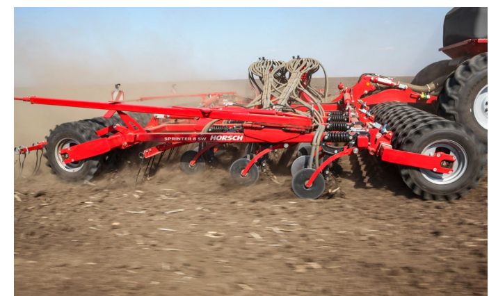
Tiefenführung über Front- und Heckpacker
