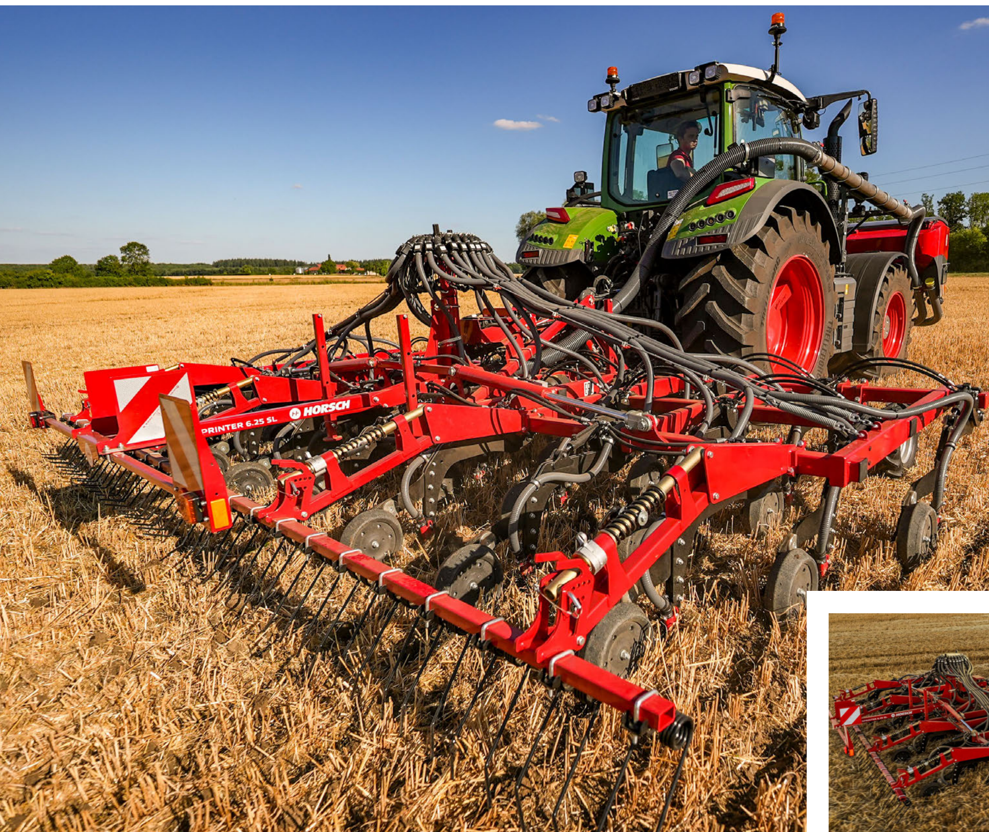
3-belkowa budowa zapewnia maksymalną przepustowość
