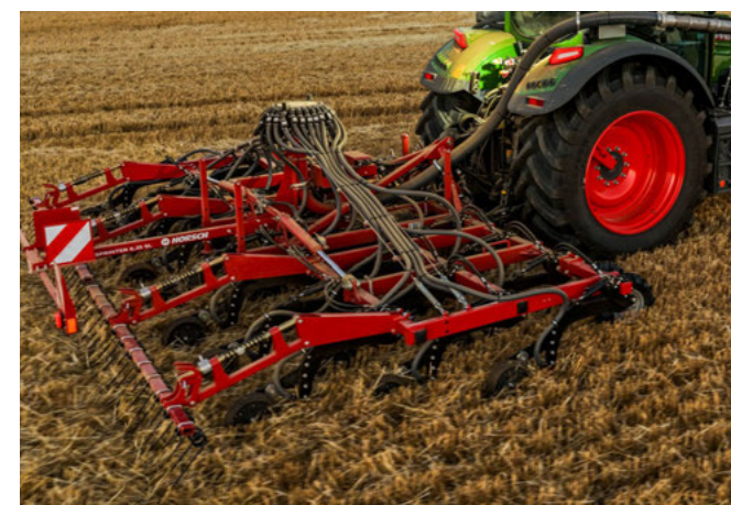
3-belkowa budowa zapewnia maksymalną przepustowość
