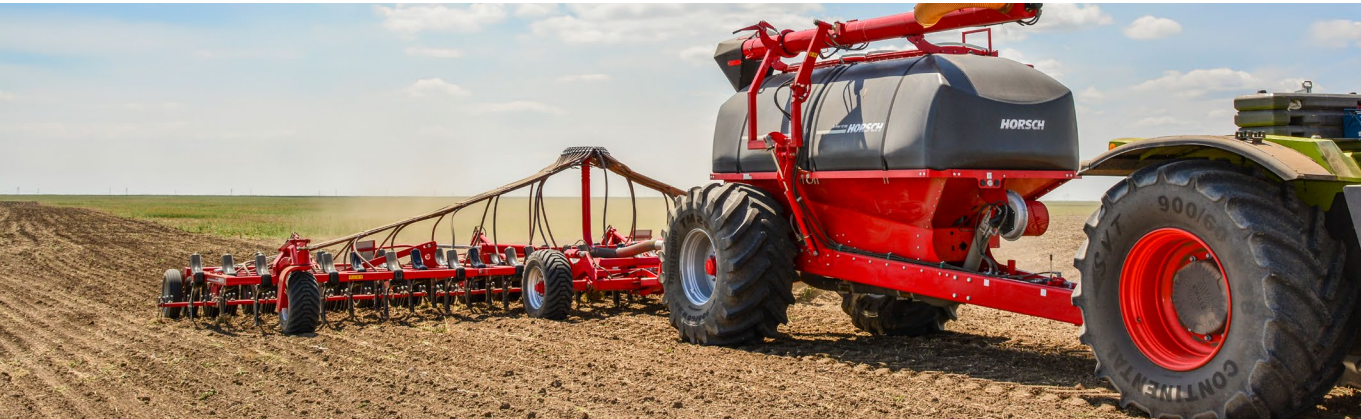
Doppeltank mit 6 000 l : 6 000 l Aufteilung oder Tripletank mit der Aufteilung 4 000 l : 2 000 l : 6 000 l Hydraulische Befüllschnecke für eine autarke Befüllung
