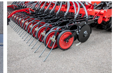
Redlica siewna HORSCH TurboDisc
