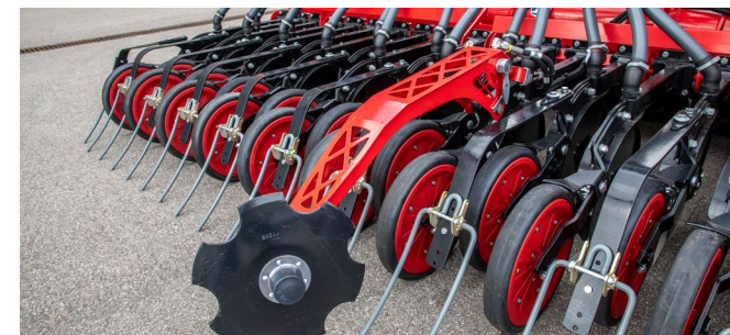
Agresywność znacznika przedwschodowego ustawia się za pomocą ogranicznika głębokości
