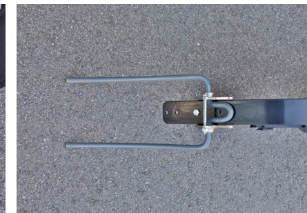
Proste zgrzebło redlicy siewnej TurboDisc prowadzone jest pojedynczo w celu skutecznej uprawy gleby
