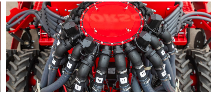
Monitorowanie przepływu powietrza w głowicy rozdzielczej.
