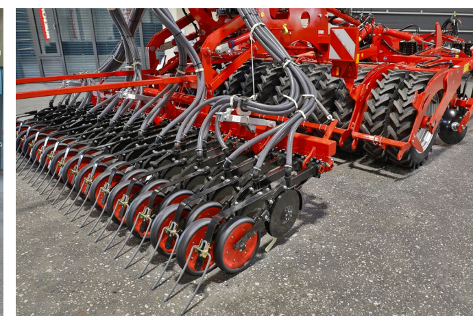
Redlica siewna TurboDisc zapewnia precyzyjne umieszczanie materiału siewnego oraz duży nacisk redlicy
