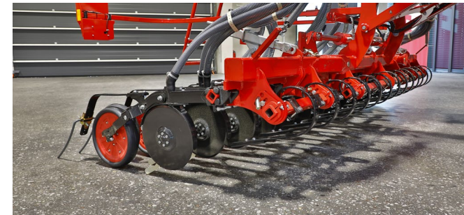
1 - rzędowa szyna niwelująca Crossbar w Pronto TD
