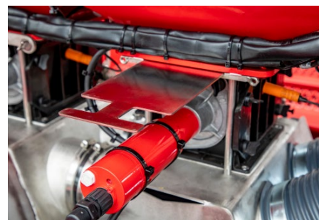
System zbiornika ciśnieniowego z otwartą zasuwą odcinającą
