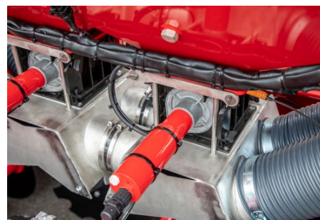
System zbiornika ciśnieniowego z możliwością odcinania dopływu nasion
