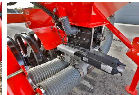
Dzięki włączeniu kontroli sekcji (SectionControl) elektryczne wyłączenie połowy szerokości można zautomatyzować.
