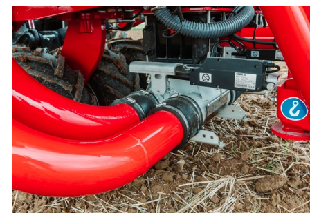
Elektryczne wyłączanie połowy szerokości roboczej – proste włączenie i wyłączenie połowy szerokości dzięki naciśnięciu przycisku na terminalu
