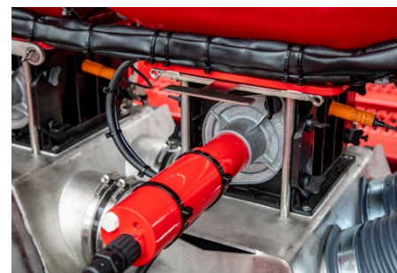
Urządzenie dozujące – system zbiornika ciśnieniowego z zasuwą odcinającą (w użyciu)
