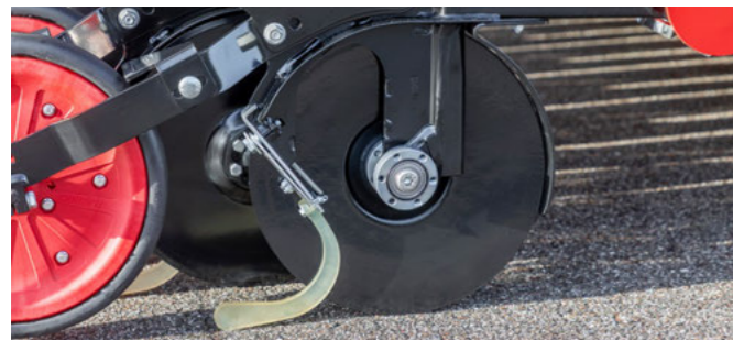
Fallrohrposition vor der Lagerung und beweglicher Innenabstreifer verhindern Verstopfungen der Schare unter feuchten Aussaatbedingungen
