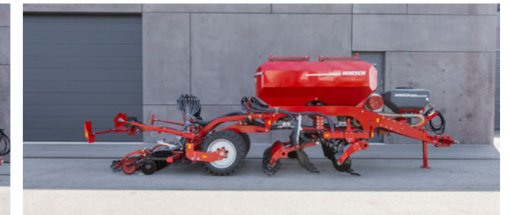
Großdimensionierter Reifenpacker für einen leichten Lauf
