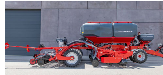
Großdimensionierter Reifenpacker zur tiefen Rückverfestigung
