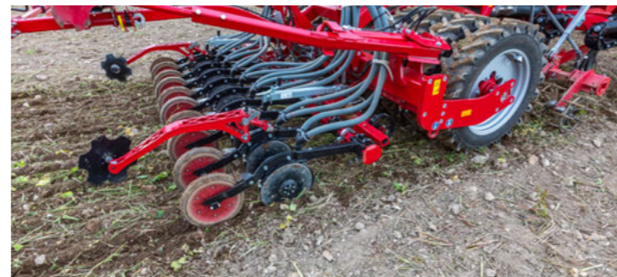
Focus 3 TD mit TurboDisc Säschiene 30 cm Reihenabstand
