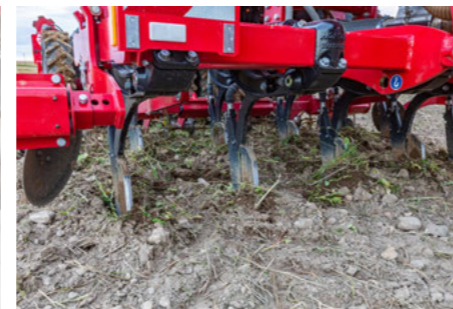
ULD Schar öffnet den Boden und legt Dünger ab
