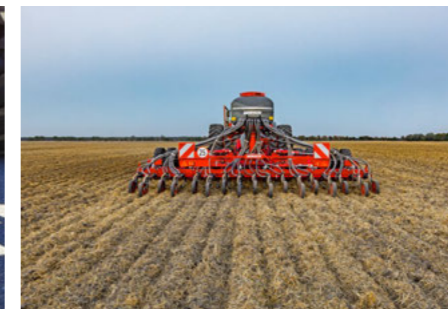
Wolna od resztek bruzda siewna dzięki zębowej redlicy siewnej TurboEdge
