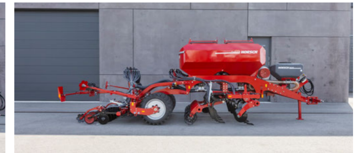
Wał oponowy o dużych oponach zapewniający lekką pracę
