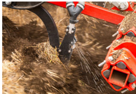
Redlica LD/Redlica LD Plus – aplikacja nawozu w górną warstwę gleby
