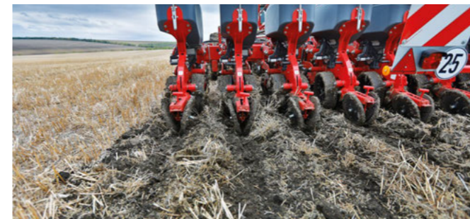
Siew StripTill z pojedynkowaniem
