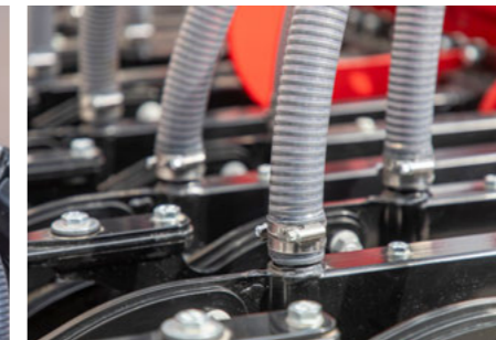
Zoptymalizowane owężowanie systemu pneumatycznego i zagłębione węże nasienne
