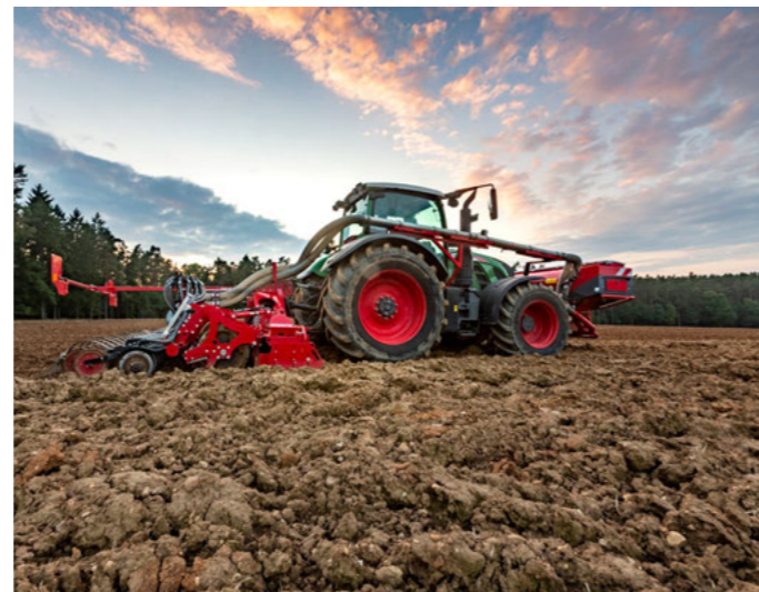
Brona wirnikowa Kreda służy do przygotowania łoża siewnego
