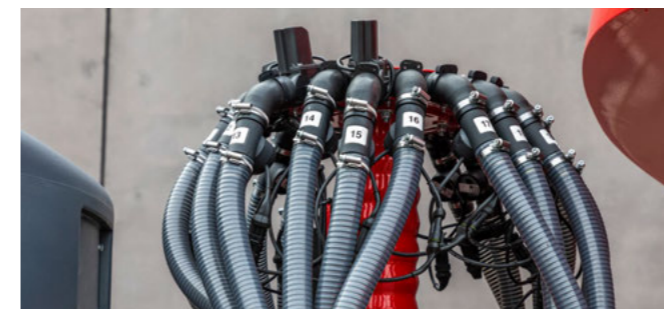
Kontrola przepływu nawozu i nasion zapewnia pełne monitorowanie węży siewnych i nawozowych
