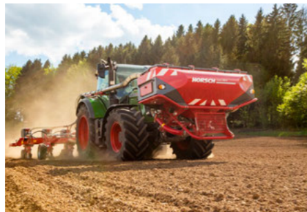
Zbiornik pojedynczy o pojemności 1 600 l
