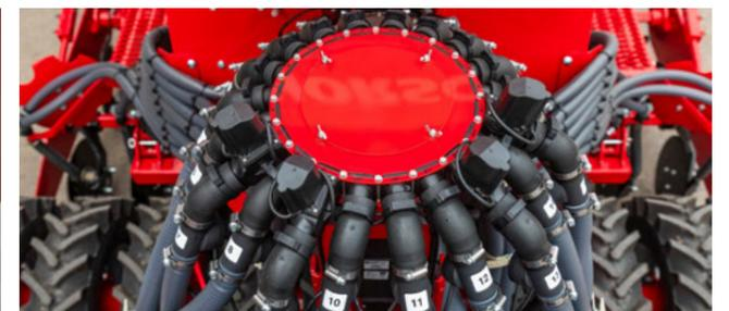
Überwachung des Pneumatikdurchflusses am Verteilerturm
