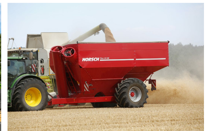
Mit der hydraulischen Teleskopachse schnell zwischen Feld und Straße wechseln
