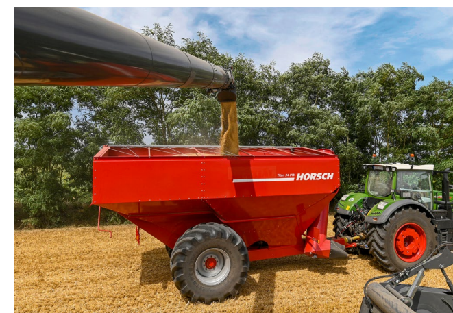
Durch 4,6 m Überladehöhe und gute Sicht flexibel einsetzbar
