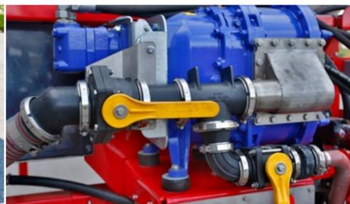
Kolbenmembranpumpen-Leistung 3 000 l/min
