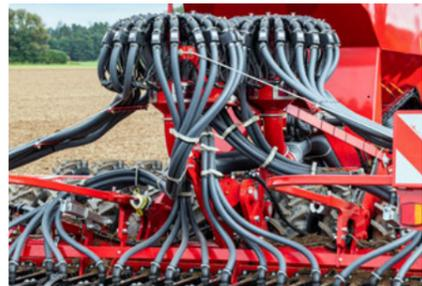
RowControl Verteilerturm – 2-Turm-Variante an der Pronto 6 & 7 DC
