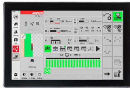
Mit der neuen Terminalgeneration eosT10 erleben Sie Maschinensteuerung auf Top Level. Durch die hohe Auflösung und die durchdachte Nutzerführung werden auch komplexe Maschinenfunktionen komfortabel bedient. Die hohe Leistungsfähigkeit und der großzügige (Arbeits-)Speicher ermöglichen ganz nebenbei das problemlose Handling großer Datenmengen oder Applikationskarten. Somit wird das Terminal zum perfekten Alleskönner für die Maschinenbedienung.
