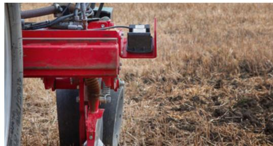
Einer der zusätzlichen Radarsensoren für ContourFarming
