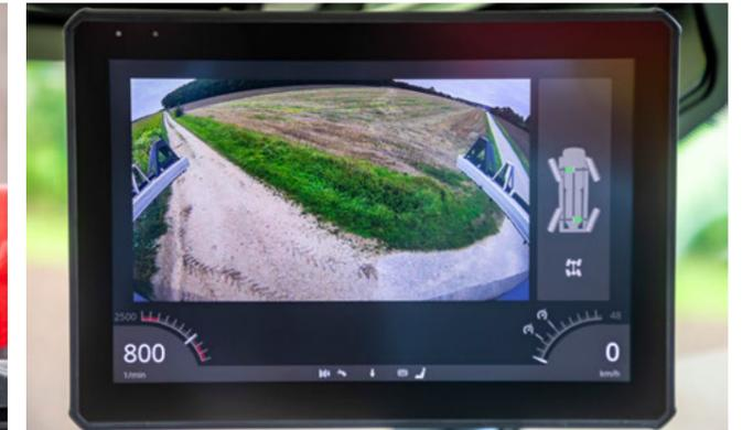
Hochauflösende, automatische Darstellung der Rückfahrkamera im A-Säulendisplay
