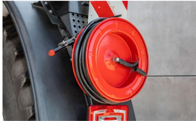
Schlauchtrommel zur Außenreinigung
