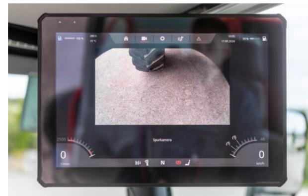
Hochauflösende, individuelle Darstellung der Spurkamera im A-Säulen-Display
