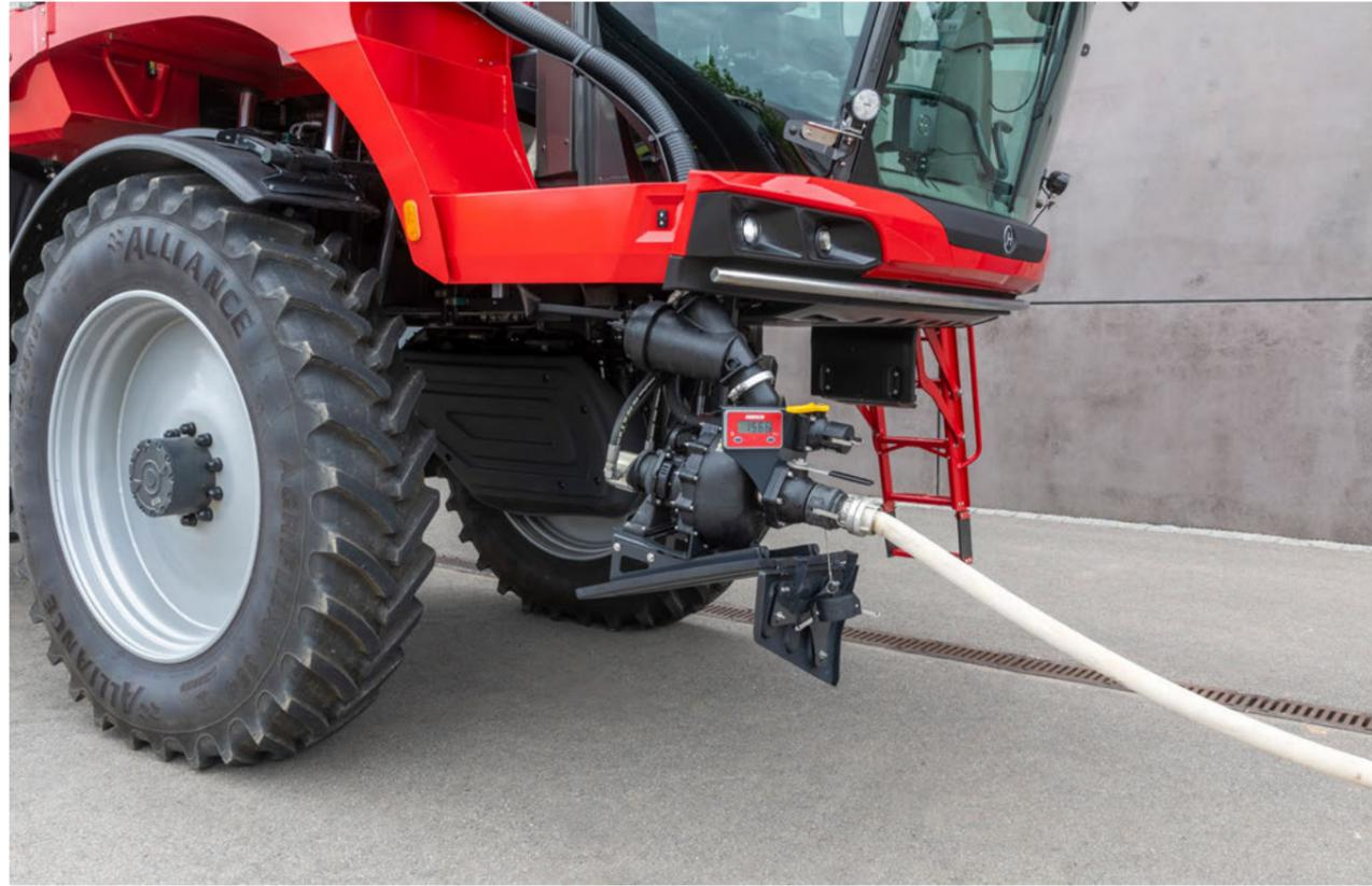
PowerFill Befüllpumpe mit 1 000 l/min Leistung - 3" Camlock Befüllanschluss vorne
