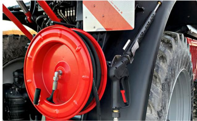
Hydraulisch betriebener Hochdruckreiniger
