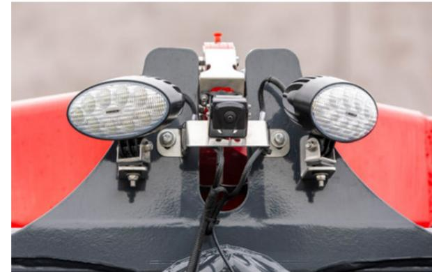
Rückfahrkamera für die Kontrolle des Bereiches hinter dem Fahrzeug
