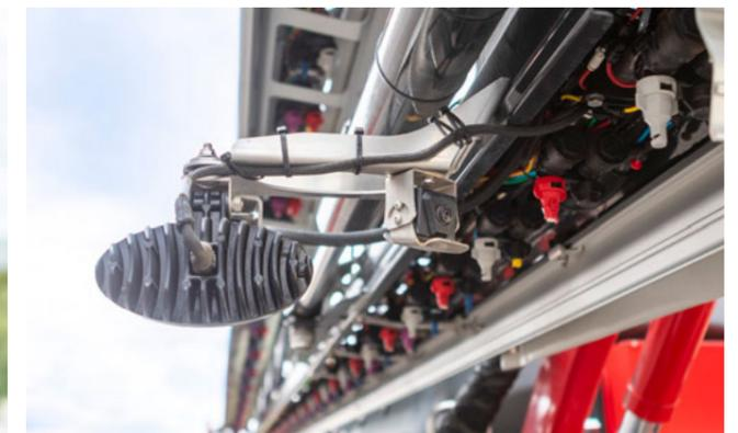
Kamera zur Düsenüberwachung am NightLight Halter
