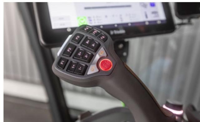
Ergonomischer Fahrhebel mit mehrfach belegbaren Tasten
