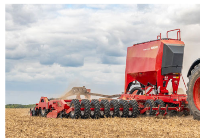
Zęby do spulchniania śladu, aby ponownie spulchnić ślad za traktorem
