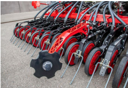
Agresywność znacznika przedwschodowego ustawiana za pomocą ogranicznika głębokości
