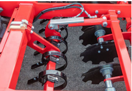
1-rzędowy Crossbar znajdujący się bezpośrednio za systemem talerzy DiscSystem jest regulowany hydraulicznie.
