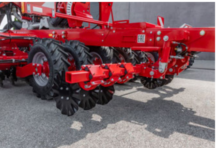
Talerze spulchniające ślady rozluźniają zagęszczenia gleby w śladzie ciągnika
