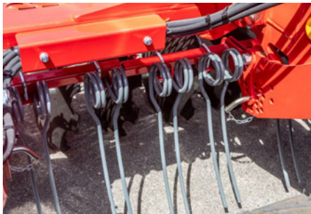
Zgrzebło jest umieszczone pomiędzy DiscSystem a wałem oponowym. Ustawienie odbywa się mechanicznie przy pomocy szablonu otworów.
