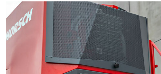
Chłodzenie oleju przy dmuchawie hydraulicznej – podgrzewa przepływ powietrza w układzie pneumatycznym
