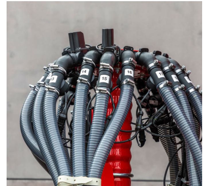
Kontrola przepływu nawozu i nasion zapewnia pełne monitorowanie węży siewnych i nawozowych
