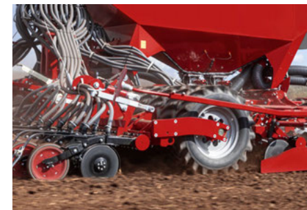
Efektywne wtórne zagęszczanie gleby pod nasionami zapewniające optymalne podsiąkanie wody
