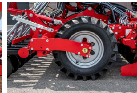
Łatwy w uciągu dzięki dużej średnicy opon oraz rezygnacji ze skrobaków
