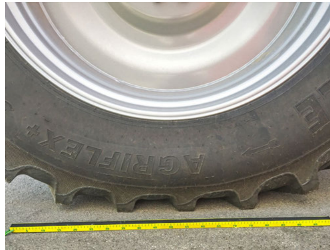
ATP Control – leichter Lauf bei 2,3 bar Reifendruck
