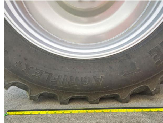
ATP Control – leichter Lauf bei 2,3 bar Reifendruck
