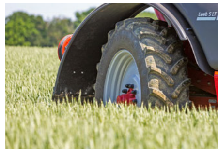
Lenkachse mit bis zu 28° Lenkeinschlag auch bei breiter Bereifung
