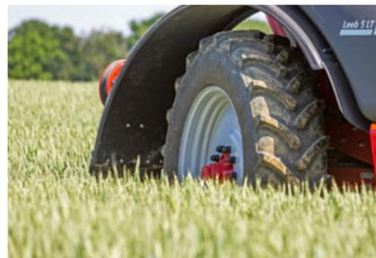
Lenkachse mit bis zu 28° Lenkeinschlag auch bei breiter Bereifung
