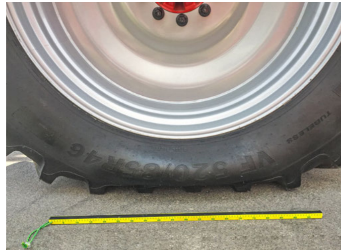
ATP Control – vergrößerte Aufstandsfläche bei 1,0 bar Reifendruck
