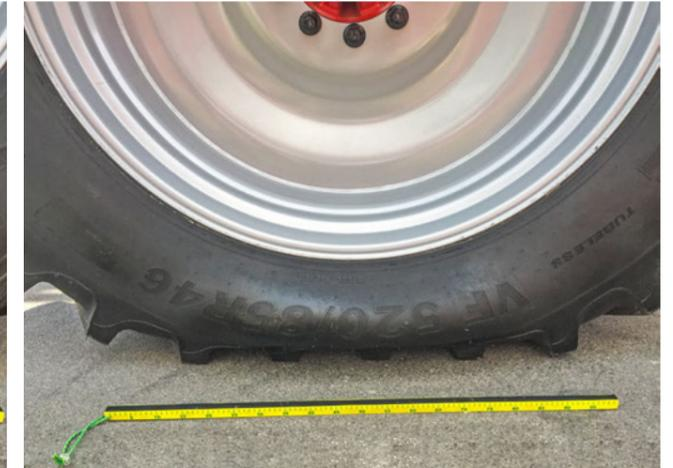
ATP Control – vergrößerte Aufstandsfläche bei 1,0 bar Reifendruck
