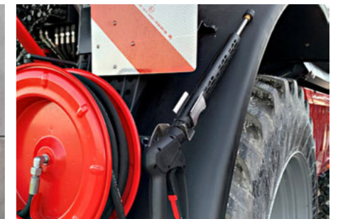
Hydraulisch betriebener Hochdruckreiniger
