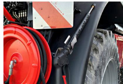
Hydraulisch betriebener Hochdruckreiniger
