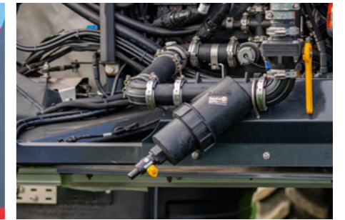
Zweiter Druckfilter im Mittelrahmen des Gestänges
