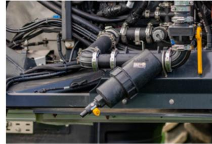
Zweiter Druckfilter im Mittelrahmen des Gestänges
