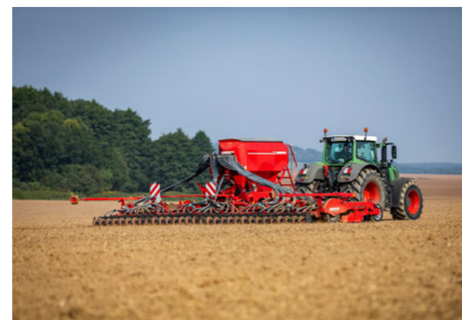
Насінневий сошник TurboDisc створений для точного висіву на високій робочій швидкості
