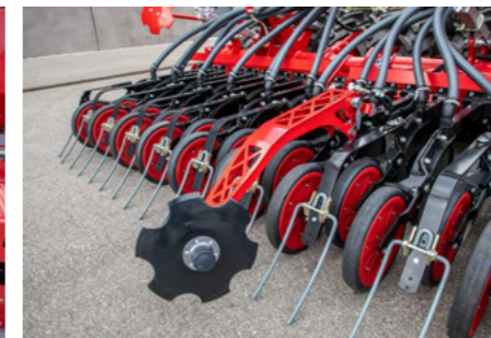
Робоча глибина маркера колії визначає агресивність його роботи.
