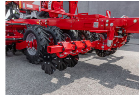
Диски для розпушення колії нівелюють ущільнення ґрунту після проходу трактора
