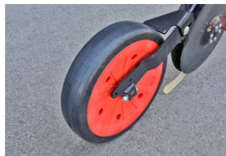
Насінневий сошник ParaDisc – прикочувальне колесо шириною 7 см
