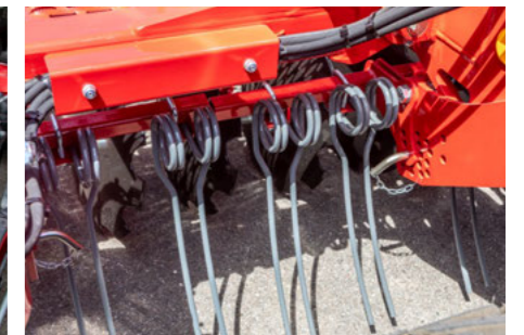
Борона розташована між DiscSystem і колісним котком. Налаштування здійснюється механічно через растр отворів.
