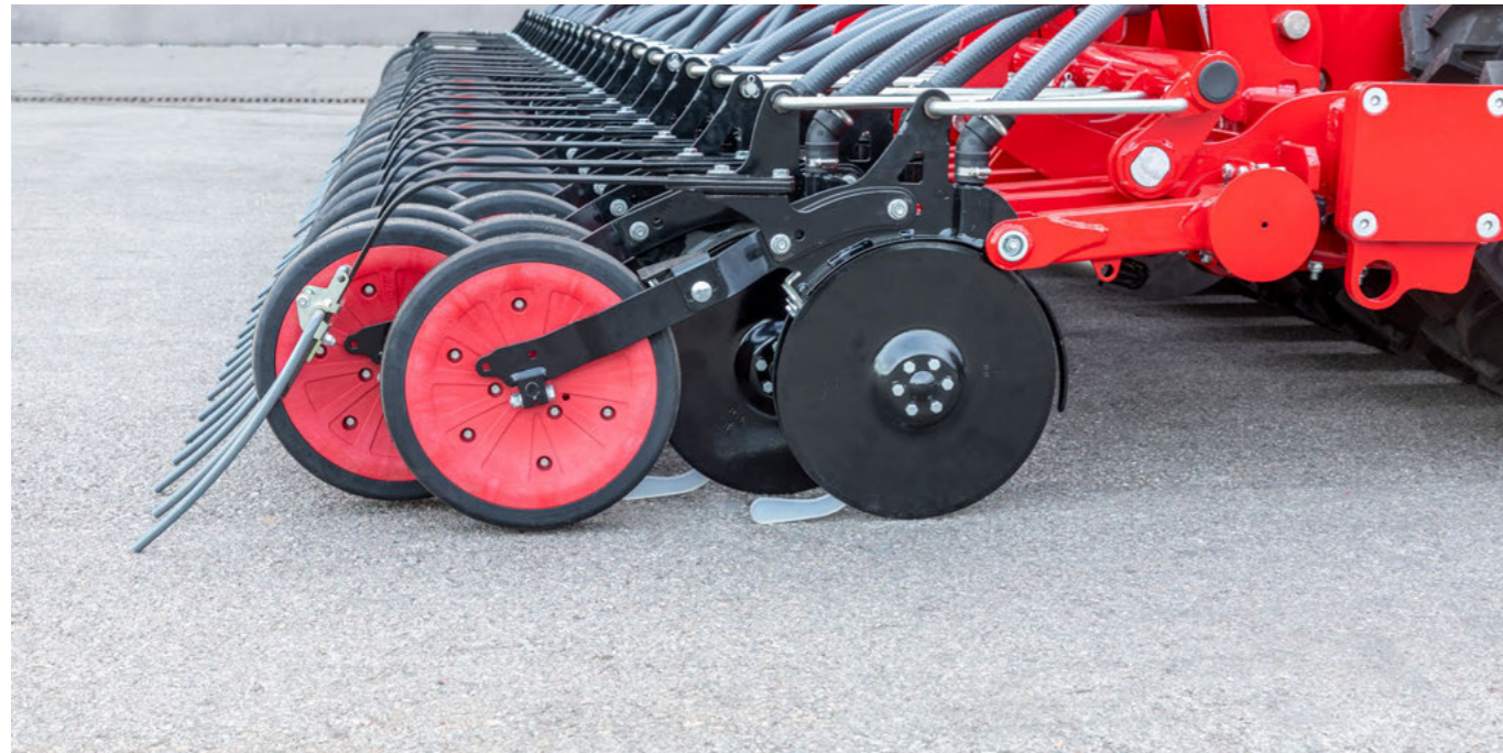
Насінневий сошник ParaDisc з максимальним притискним зусиллям 150 кг
