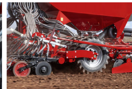
Ефективне глибоке прикочування посівної борозни для оптимального надходження вологи до насінин
