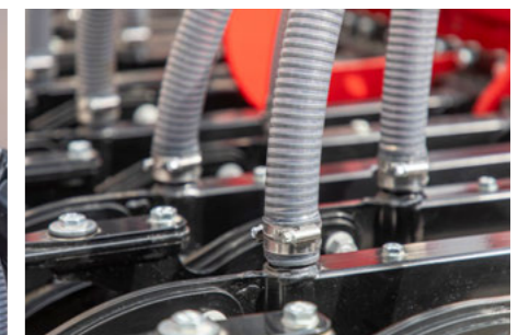
Оптимізоване прокладення пневматичних шлангів і змінений кут насіннепроводів
