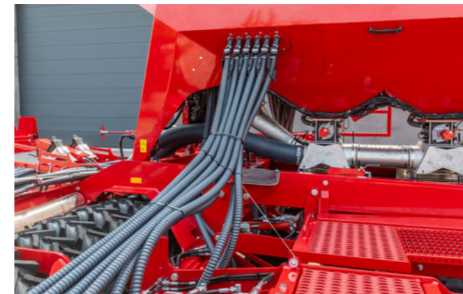
Двосекційний бункер PPF на Pronto 9 DC з розподільними баштами
