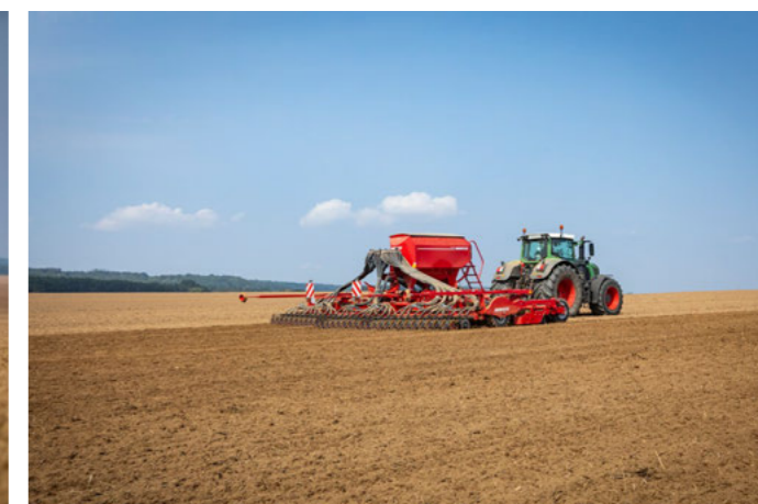
Опційна подвійна розподільна башта робить можливим відключення висіву на половину робочої ширини захвату
