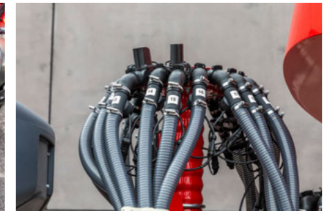
Контроль потоку насіння й добрив — для безперервного контролю за насінне- й тукопроводами
