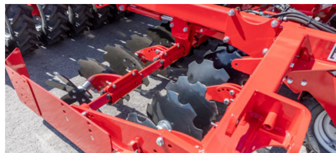
Система дисків DiscSystem Pronto DC з рамою для кріплення розпушувачів колії трактора
