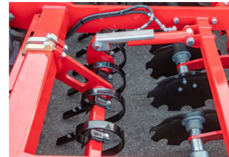
Однорядний вирівнювач Crossbar з гідравлічним регулюванням безпосередньо за дисковою системою.
