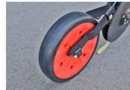
Насінневий сошник ParaDisc - прикочувальне колесо шириною 7 см
