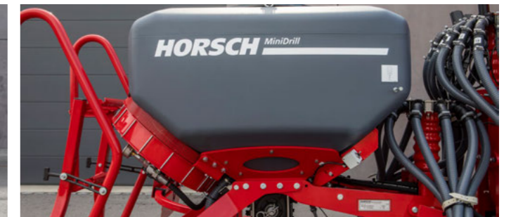
Автономна версія MiniDrill має власний компресор, власну пневматичну систему й власні сошники
