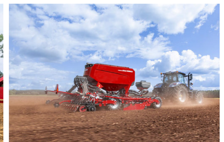
Двосекційний бункер із системою PPF дає змогу дозувати й вносити два окремі компоненти в два різні горизонти
