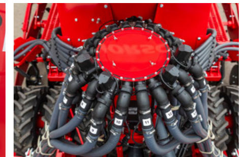
Сенсори потоку на розподільній башті
