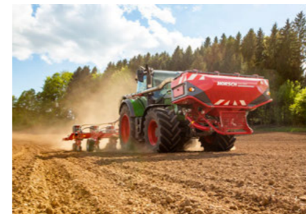
Односекційний бункер об'ємом 1600 л
