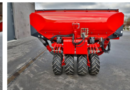
Коток з 4-ма колесами шириною 1,30 м та додаткові баласты
