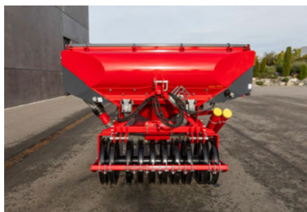
Коток RollPack забезпечує глибоке стрічкове прикочування ґрунту
