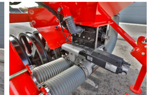
Partner 1600 FT з електричним відключенням висіву на половину робочої ширини захвату
