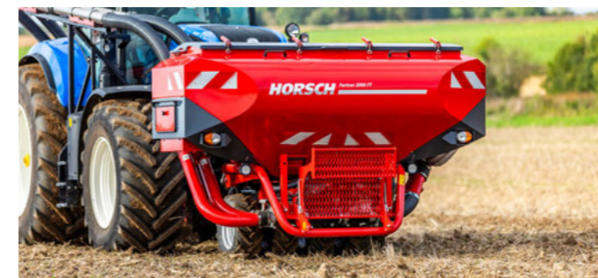
Partner 2000 FT з розподілом 60 : 40 дає змогу вносити насіння і добрива, два види насіння або два різні види добрив.
