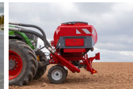
Колісний коток подрібнює та притискає грудки землі
