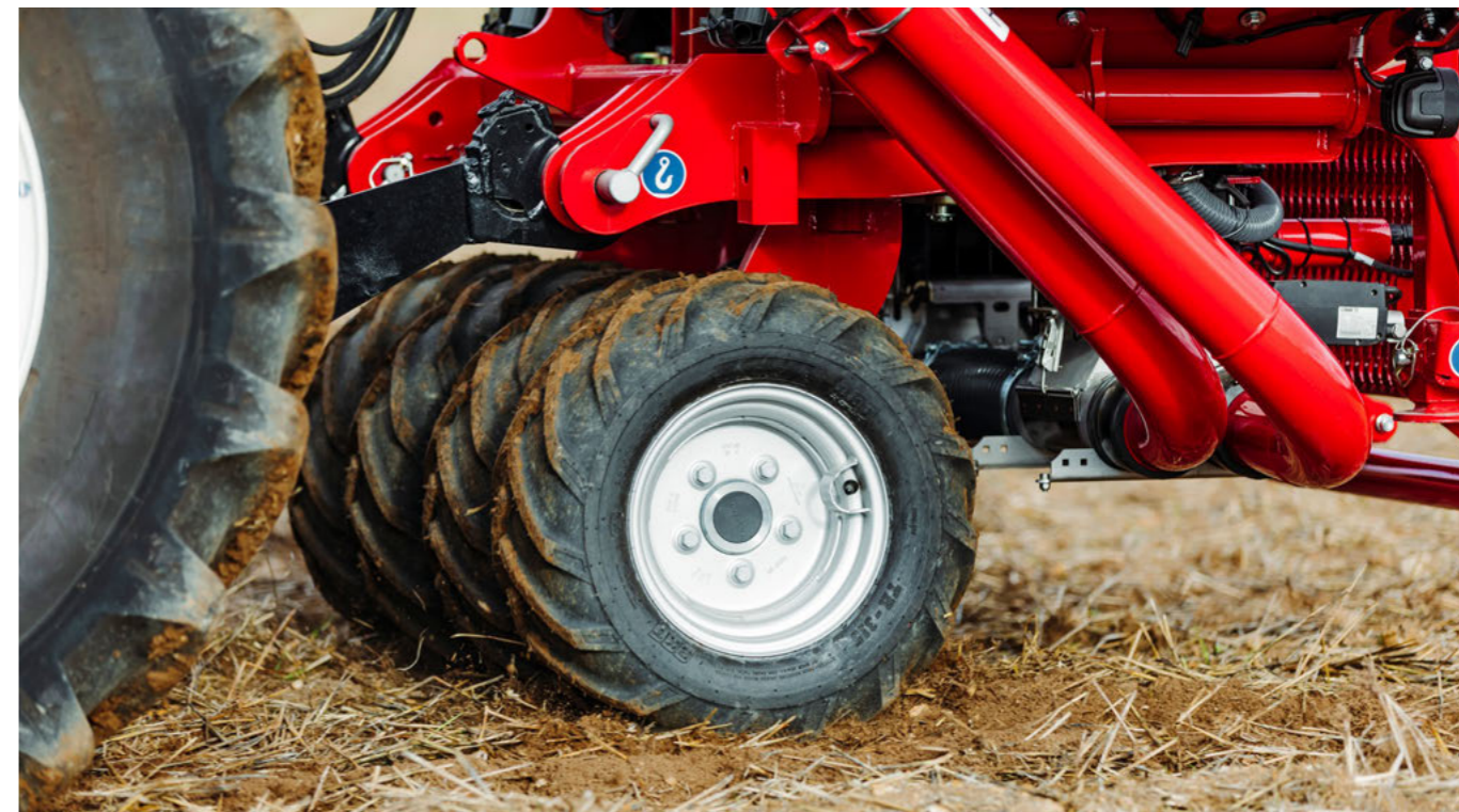
Колісний коток мінімізує ущільнення ґрунту під час роботи в полі
