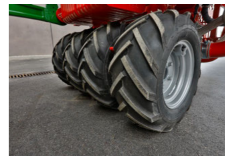
Колісний коток з пасивним кутом повороту 20°
