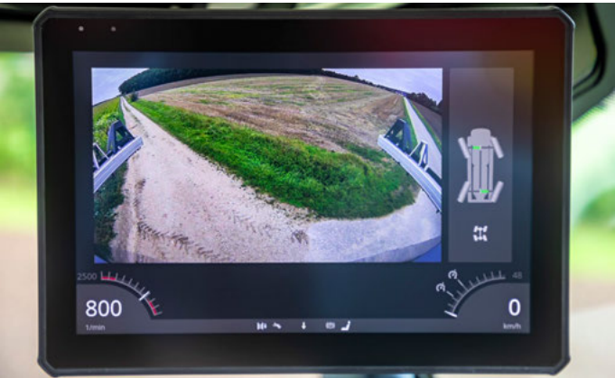
Автоматичне виведення високороздільного зображення з камери заднього огляду на дисплей у консолі А
