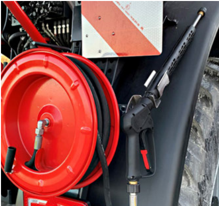
Мийка високого тиску з гідравлічним приводом
