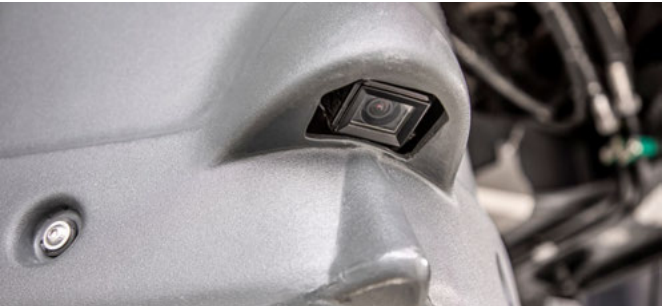
Камера, встановлена на крилі колеса
