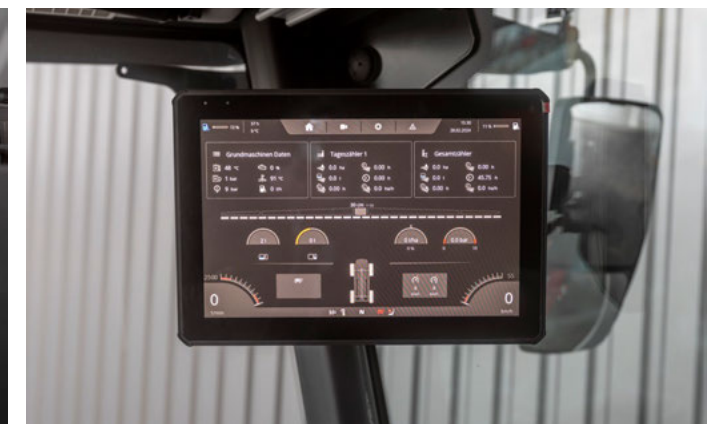
Серійний 12" дисплей в А-консолі з довільною конфігурацією виведення інформації
