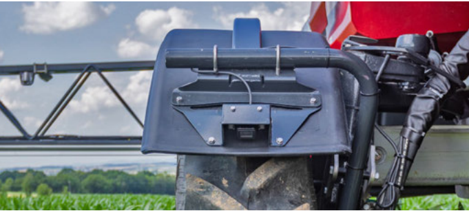
Камера з оглядом правого переднього колеса і зони перед ним
