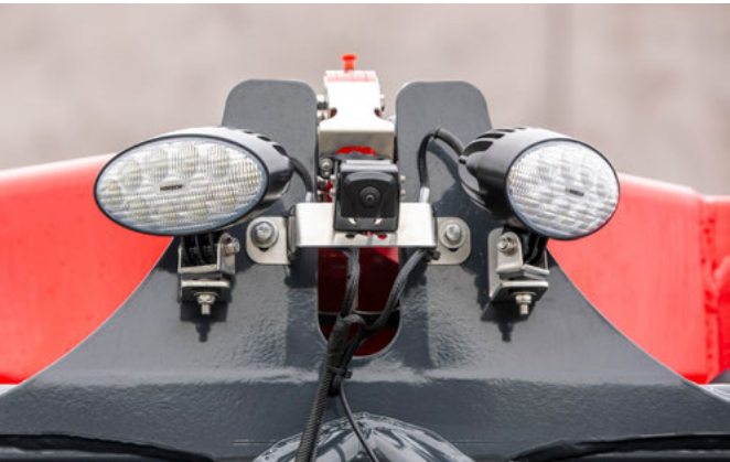
Камера заднього огляду для контролю зони позаду обприскувача
