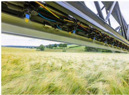
Пневматичне перемикання форсунок і секцій штанги
