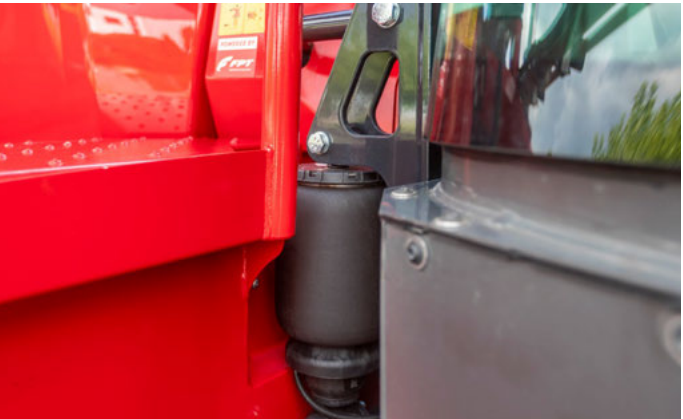
Пневматична 4-точкова підвіска кабіни
