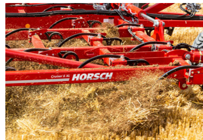
Пружинне кріплення стійок HORSCH із зусиллям спрацювання 150 кг
