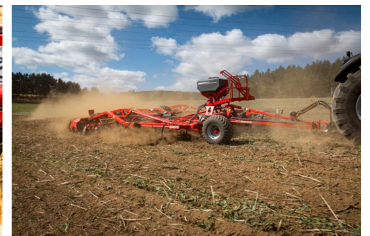
Із крилами лап завширшки 20 см можливий також суцільний зріз
