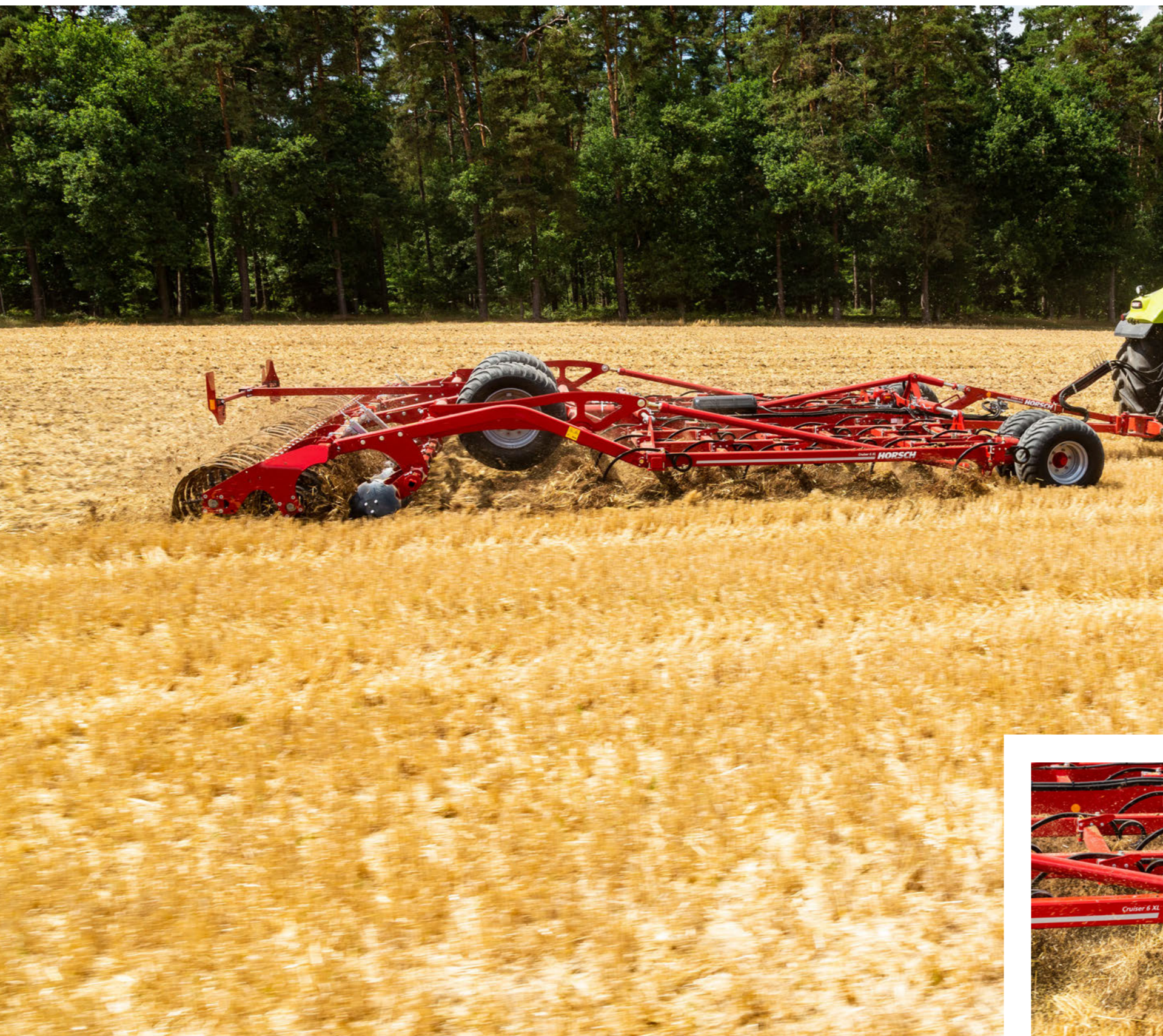
Пружинне кріплення стійок HORSCH із зусиллям спрацювання 150 кг
