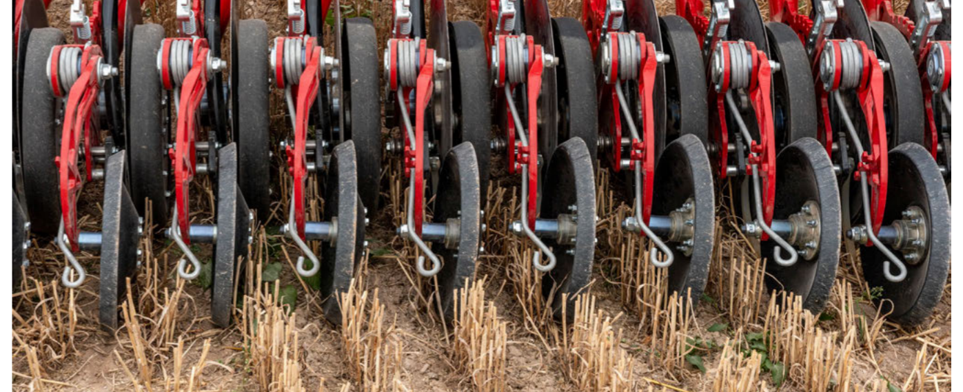
Однодисковий сошник NarrowDisc з міжряддям 20 см
