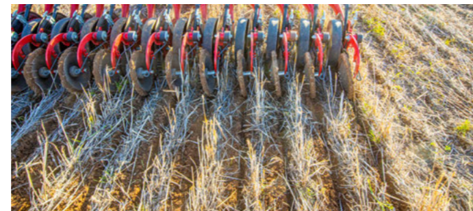
Сошники SingleDisc завдяки своїй особливій конструкції забезпечують лише мінімальне втручання в ґрунт
