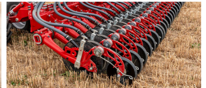
Однодисковий сошник NarrowDisc з незалежним веденням за глибиною
