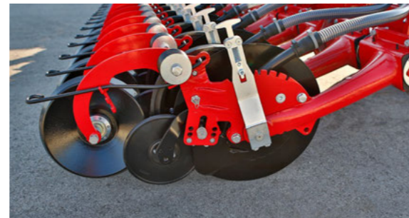
Гладкі сталеві прикочувальні колеса для будь-яких умов
