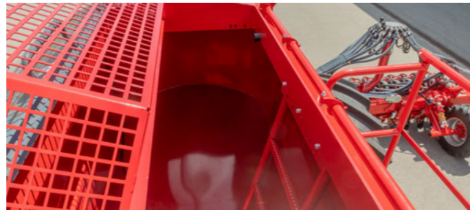
Відкидний сітчастий фільтр, який запобігає засміченню бункера
