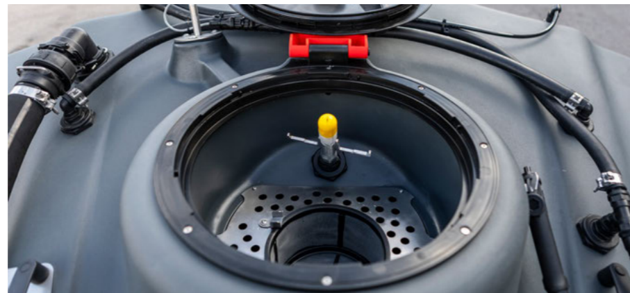
Einspülmöglichkeit im Dom mit Kanisterreinigung
