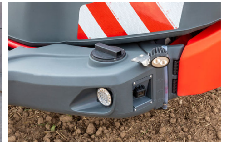
Frischwassertank mit Kamerasystem und Vorfeldbeleuchtung
