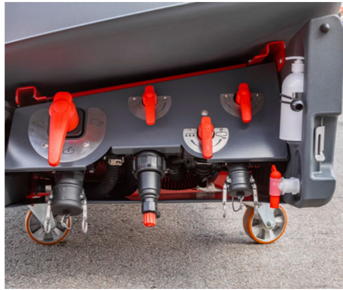
Wassersystem mit hydraulischer Pumpe und manuellen Mehrweghähnen
