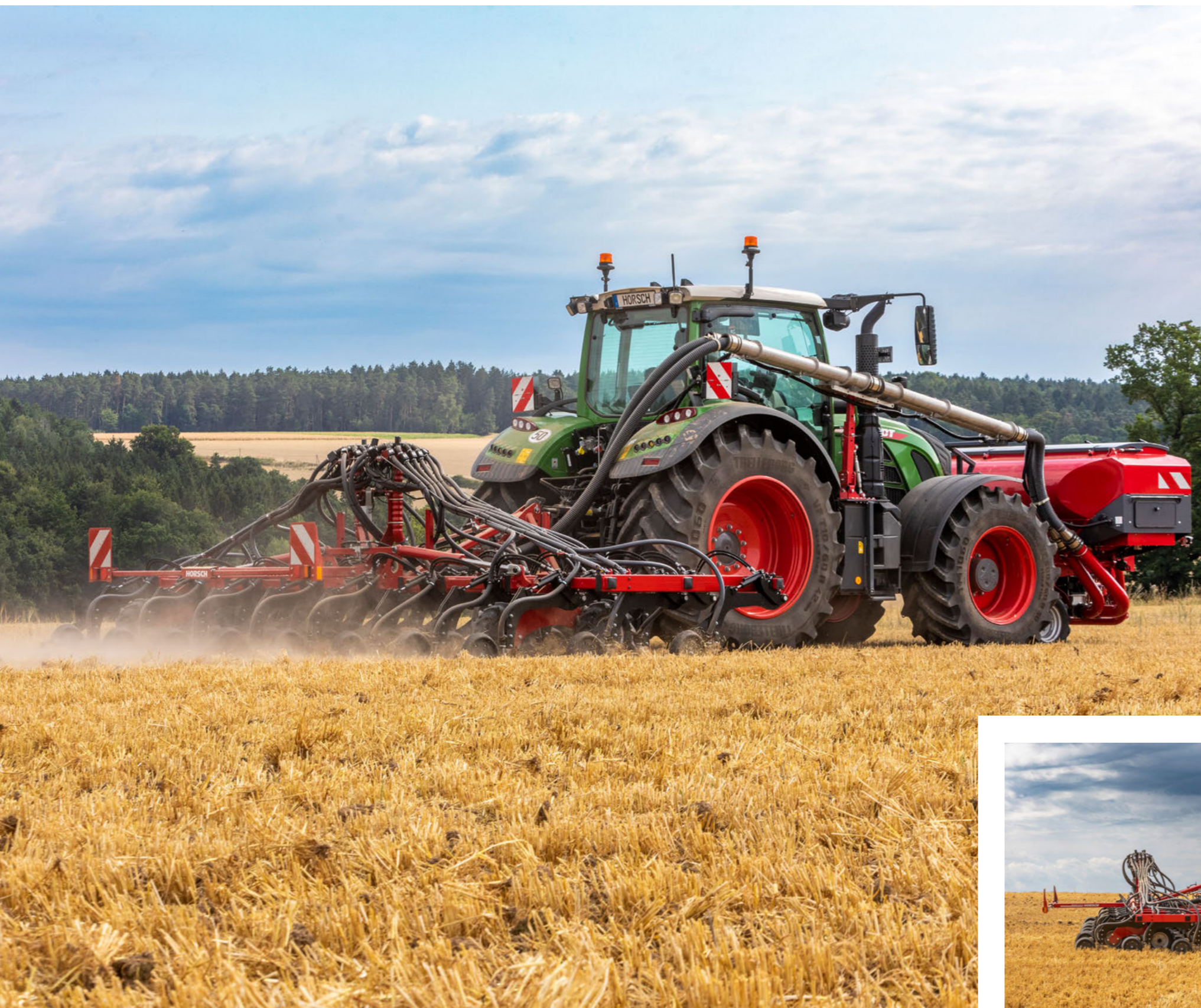
3-balkiger Aufbau für maximalen Durchgang
