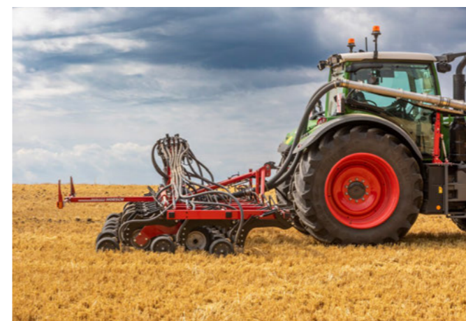
3-balkiger Aufbau für maximalen Durchgang
