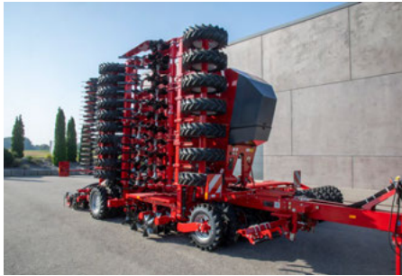
Repliage unilatéral sur le Pronto 9 DC
