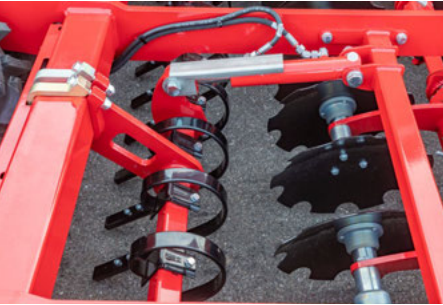
La Crossbar située à l’arrière du DiscSystem est dotée d’un réglage hydraulique
