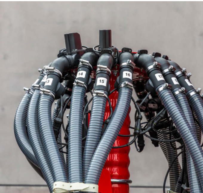
Contrôle du flux d’engrais et de semences – pour un contrôle en continu du système de distribution en engrais et semence
