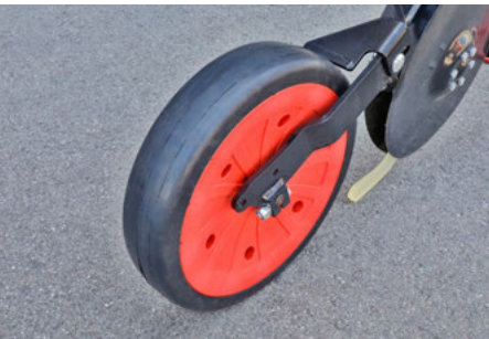
Elément semeur ParaDisc – roue plombreuse de 7 cm de large
