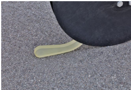
L’Uniformer HORSCH (languette en téflon) garantit un placement précis de la semence au fond du sillon
