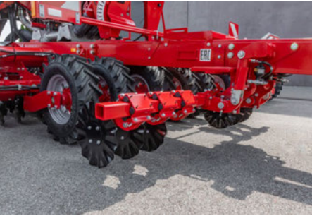
Les diques efface-traces ameublissent les compactations dans les traces du tracteur
