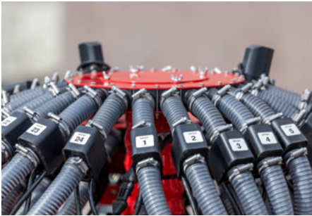
Système pneumatique spécifique pour les céréales vêtues
