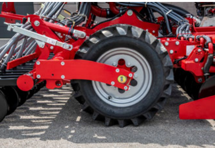
Faible demande de puissance grâce aux pneus de grand diamètre dépourvus de décrotteurs
