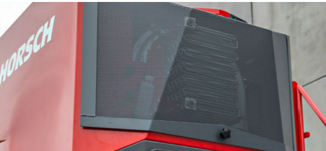
Refroidissement de l’huile sur la soufflerie hydraulique – réchauffe le flux d’air dans le circuit pneumatique
