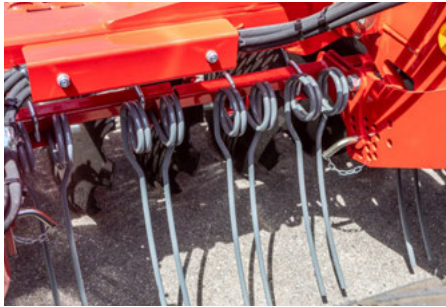
La herse est placée entre le DiscSystem et le packer à pneus. Le réglage est opérée mécaniquement via un axe.
