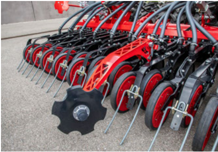
L’agressivité du traceur de pré-levée est réglée via une butée de profondeur.
