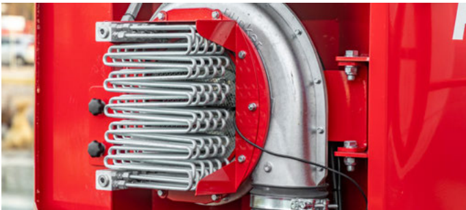
Abaisse la température de l’huile dans le système et déleste le refroidisseur d’huile du tracteur
