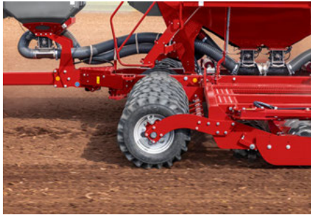
Possibilité de diminuer le tassement dû aux traces du tracteur dans le lit de semences
