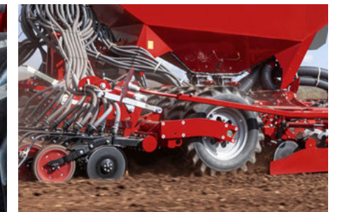
Effektive Rückverfestigung unter dem Saathorizont für optimale Wasserführung zum Saatkorn
