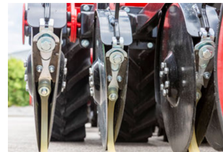
Der bewegliche Abstreifer garantiert eine hohe Selbstreinigung unter feuchten Bedingungen
