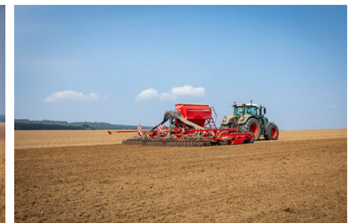
Optionale Doppelturmvarianten ermöglichen eine Halbseitenabschaltung
