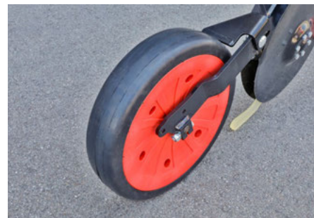
7 cm breite Andruckrolle – ideal auf leichten Böden
