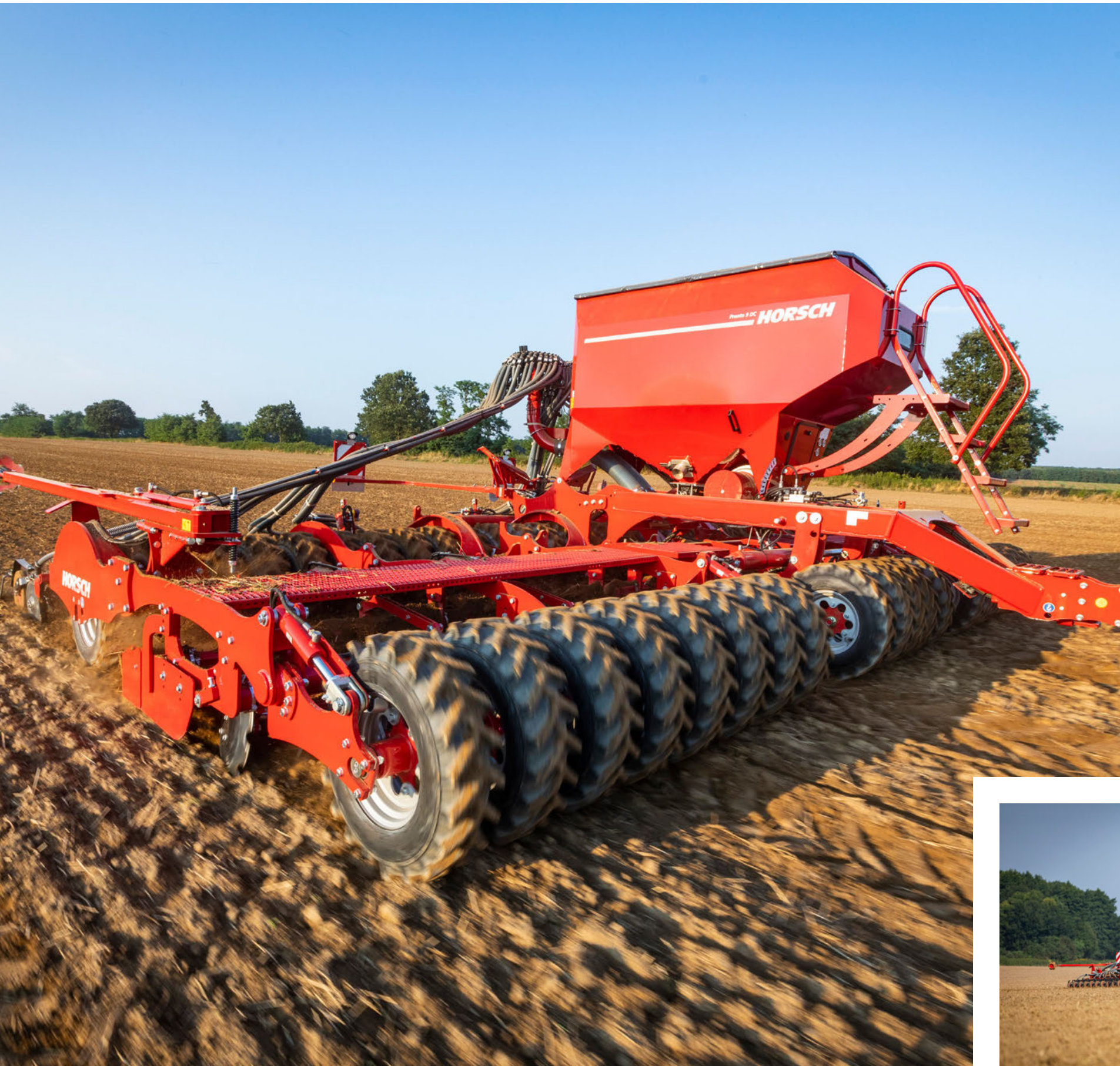
Das TurboDisc Säschar ist für die präzise Saatgutablage bei hohen Fahrgeschwindigkeiten konzipiert
