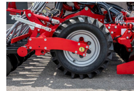
Hohe Leichtzügigkeit durch großen Reifendurchmesser und nicht benötigte Abstreifer
