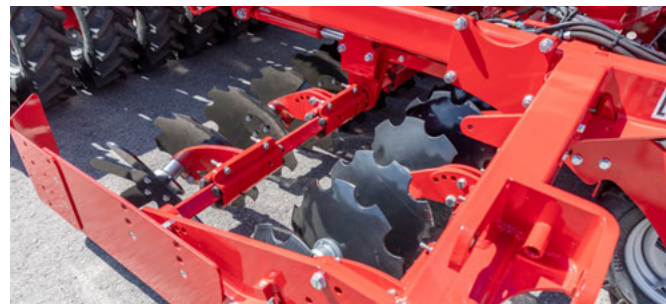
DiscSystem Pronto DC mit Anbaurahmen für Spurlockerscheiben
