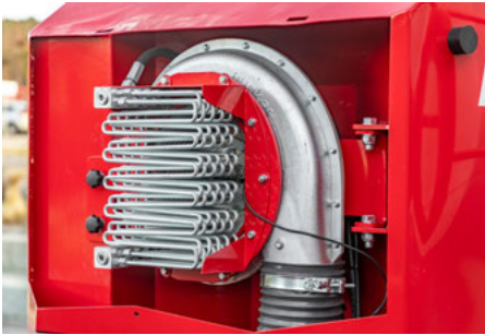
Abaisse la température de l’huile dans le système et déleste le radiateur d’huile du tracteur
