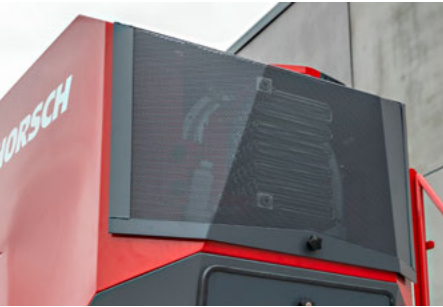
Refroidissement de l’huile sur la soufflerie hydraulique – réchauffe le flux d’air dans le circuit pneumatique
