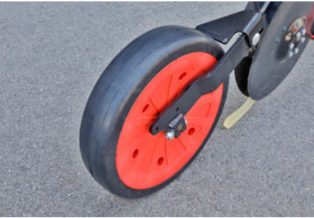
Élément semeur ParaDisc – roue plumbeuse de 7 cm de large
