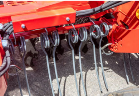
La herse est placée entre le DiscSystem et le packer à pneus. Le réglage est opérée mécaniquement via des axes
