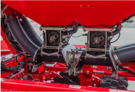
Double cuve G&F – doser séparément différents produits et les déposer ensemble via l’élément semeur
