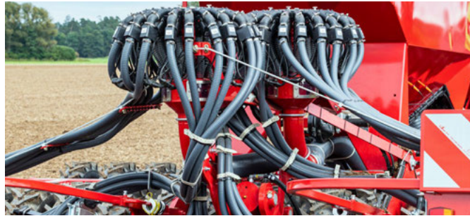
RowControl – configuration double tête de distribution sur le Pronto 6 & 7 DC
