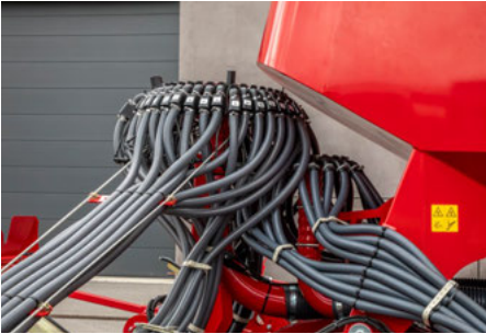
Tête de distribution PPF en option pour une accessibilité optimale
