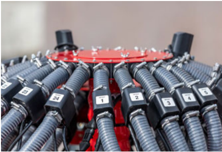
Système pneumatique spécifique pour les céréales vêtues
