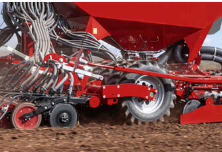
Rappui efficace sous l'horizon de semis pour une remontée de l'humidité par capillarité
