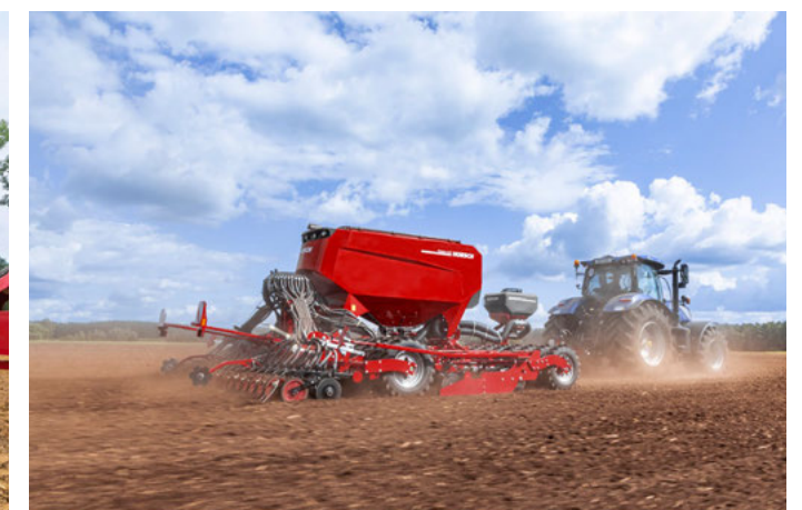
La double cuve PPF permet le dosage et le dépôt séparés de deux produits sur 2 horizons
