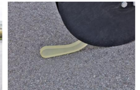
Der HORSCH Uniformer - TurboDisc Säschar gewährleistet eine präzise Saatgutfixierung
