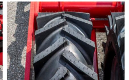
Gerades Reifenprofil erhöht die Rückverfestigung im Randbereich
