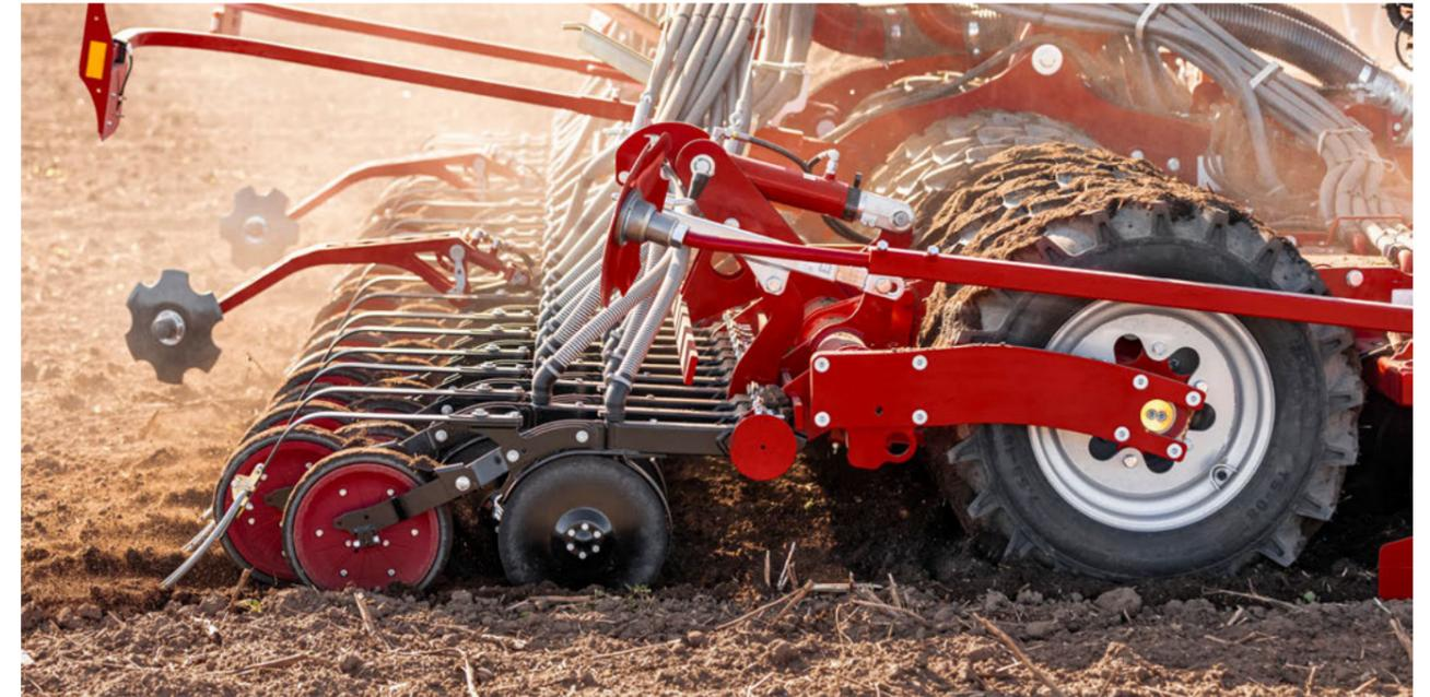
Der HORSCH Reifenpacker garantiert eine gezielte und gleichmäßige Einebnung und Rückverfestigung vor jedem Säschar. Die Reifen sind auf einer Linie angeordnet. So ist der Durchgang auch auf leichten Standorten optimal. Das gerade Reifenprofil erhöht die Rückverfestigung im Randbereich. Eine besonders gute Haltbarkeit wird durch die zehnlagigen HORSCH Spezialreifen gewährleistet.
