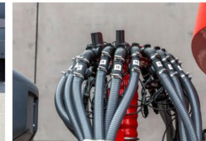
Dünger- und Saatflusskontrolle - für eine lückenlose Überwachung der Saat- und Düngerschläuche
