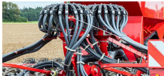
RowControl Verteilerturm - 2-Turm-Variante an der Pronto 6 & 7 DC
