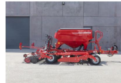
Pronto 4 DC mit 1-reihigem Striegel hinter dem DiscSystem
