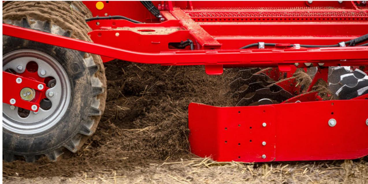
Die 46 cm großen Scheiben mit gezacktem Profil erreichen sehr hohe Umdrehungsgeschwindigkeiten und besitzen ein sehr gutes Einzugsverhalten. So wird der Boden sehr aggressiv durchmischt, wichtige Feinderde produziert und das Saatbett etwas eingeebnet. Der Durchgang ist aufgrund der paarweisen Anordnung der Scheibenelemente optimal. Dies erhöht zusätzlich die Zuverlässigkeit der Maschine. Durch die hydraulische Tiefeneinstellung ist die Arbeitstiefe während der Fahrt stufenlos regelbar.
