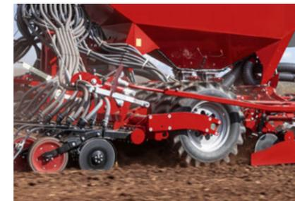
Effektive Rückverfestigung unter dem Saathorizont für optimale Wasserführung zum Saatkorn
