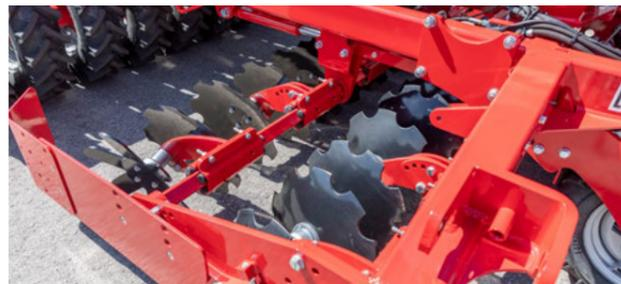
DiscSystem Pronto DC mit Anbaurahmen für Spurlockerscheiben
