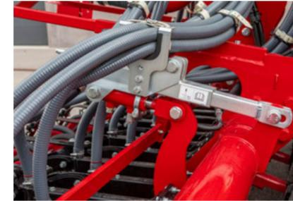
Über das Traktorsteuergerät kann der Scharddruck erhöht werden
