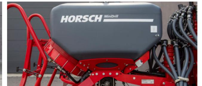
Die autarken MiniDrill Varianten besitzen ein eigenes Gebläse, ein eigenes Pneumatiksystem und einen weiteren Ablagehorizont
