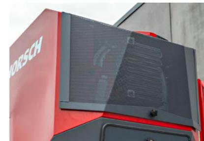
Ölkühlung am hydraulischen Gebläse - erwärmt den Luftstrom im Pneumatiksystem
