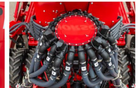
Überwachung des Pneumatikdurchflusses am Verteilerturm
