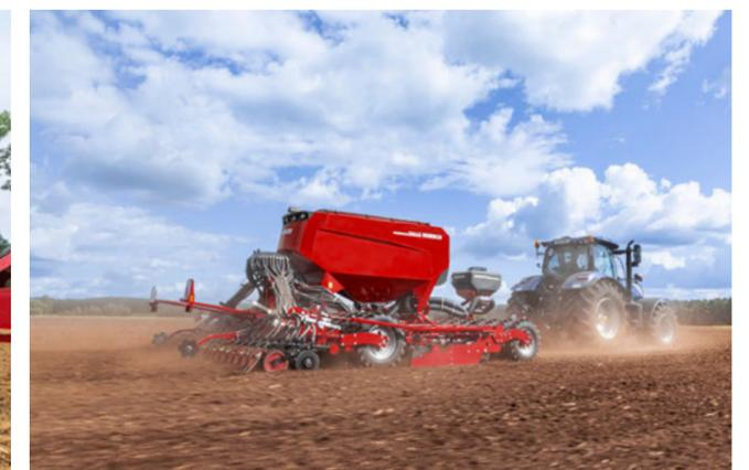
Das Doppeltanksystem PPF ermöglicht das separate Dosieren und Ablegen von 2 Komponenten auf 2 Horizonten
