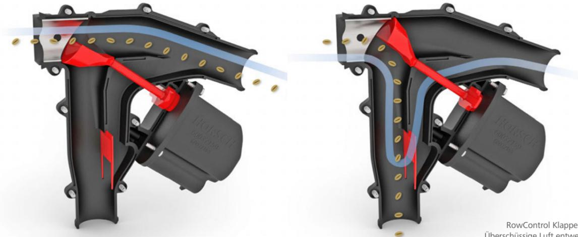
RowControl Klappe geöffnet: Saatgut wird an das Säschar gefördert
