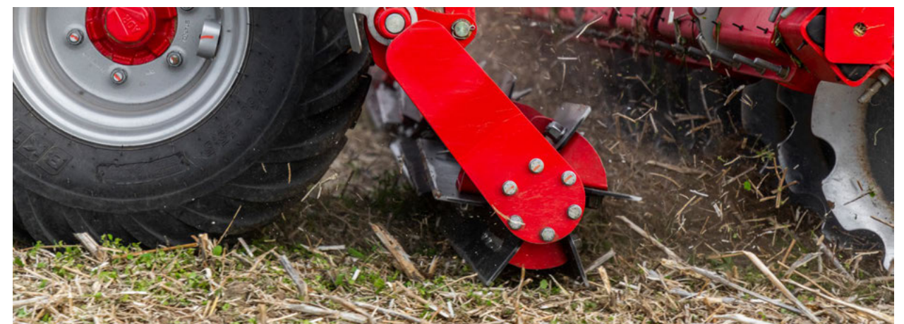
Vorlaufende Messerwalze für ideale Zerkleinerung
