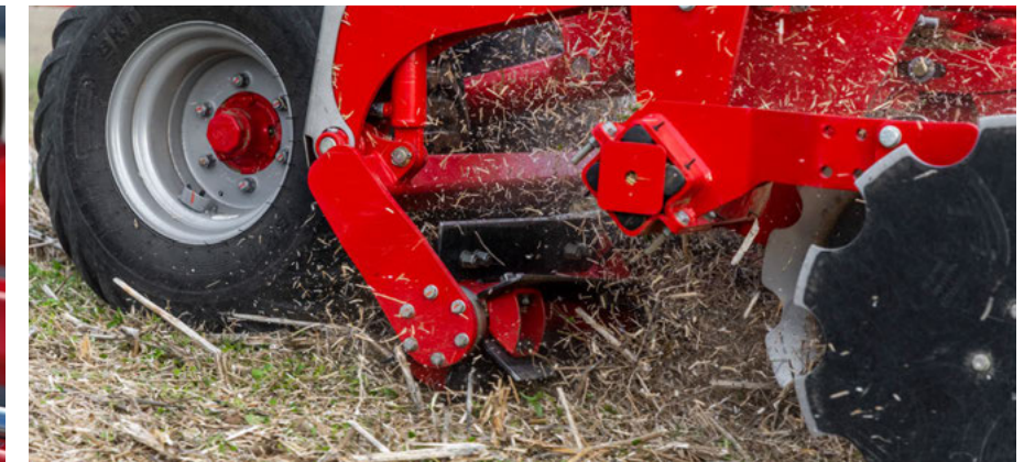
Aufwirbeln von Stroh durch die Messerwalze
