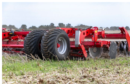
Doppelstützräder vorlaufend zur idealen Boden­anpassung
