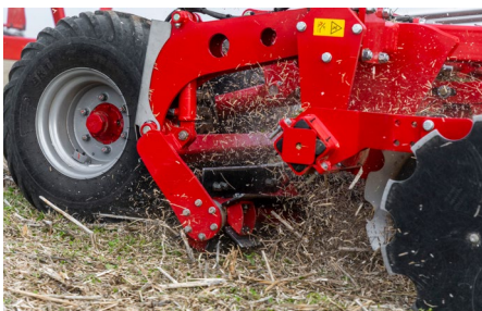
Aufwirbeln von Stroh durch Messerwalze
