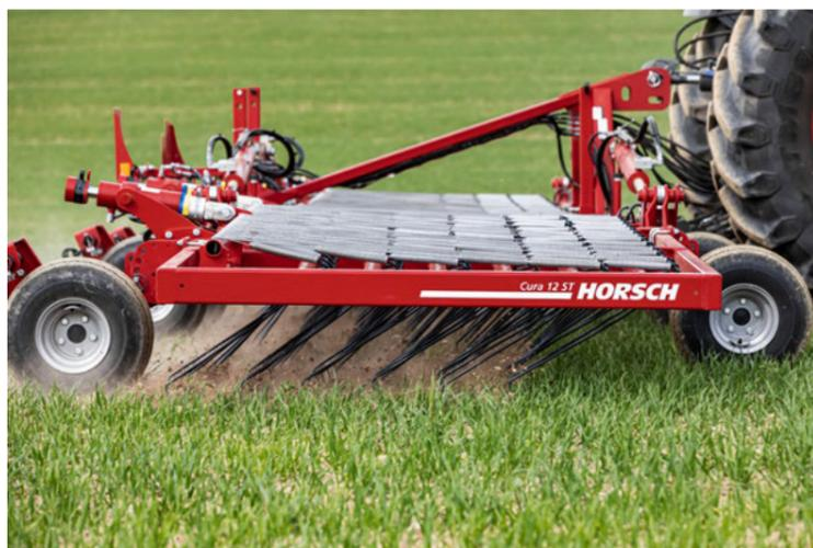
Dents précontraintes grâce à un système de pression hydraulique avec double ressort
