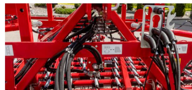
En option, l'électrovanne permet de faire l'économie d'un distributeur et est positionnée en sécurité entre les points d'attelage.
