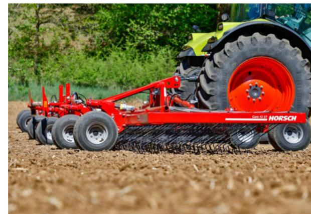
Le châssis s'adapte au sol par le biais des roues de support
