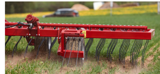
Stützräder versetzt angeordnet, so dass die Kultur nicht doppelt überfahren wird
