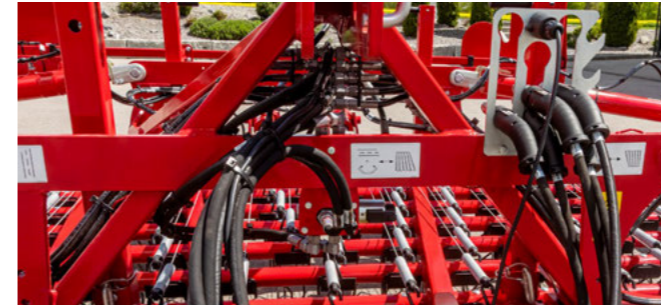
Das optionale Elektromagnetventil spart ein Steuergerät ein und sitzt geschützt zwischen den Koppelpunkten
