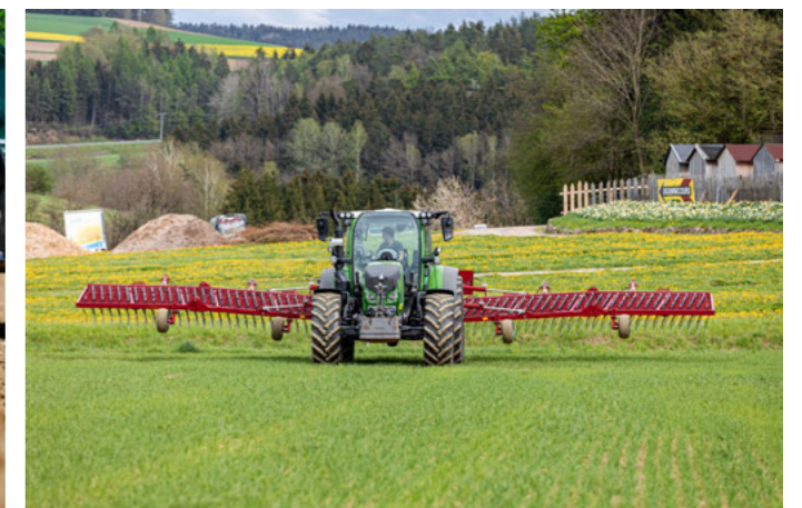
Vorgewendestellung sorgt für mehr Bodenfreiheit beim Wenden
