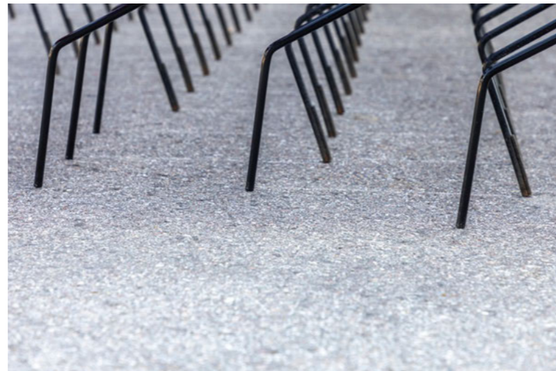
Vergleich Striegelzinken 100° und 125°
