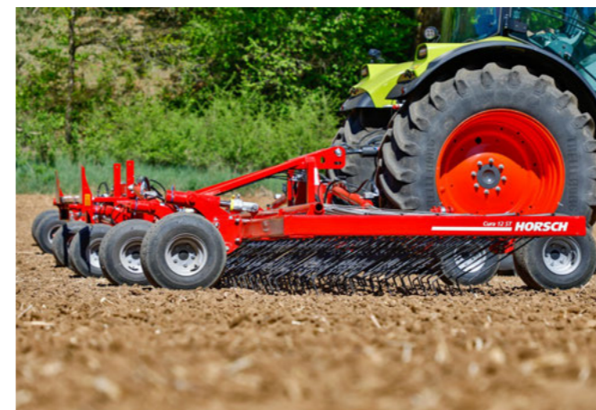
Der Rahmen passt sich durch die Stützräder dem Boden an
