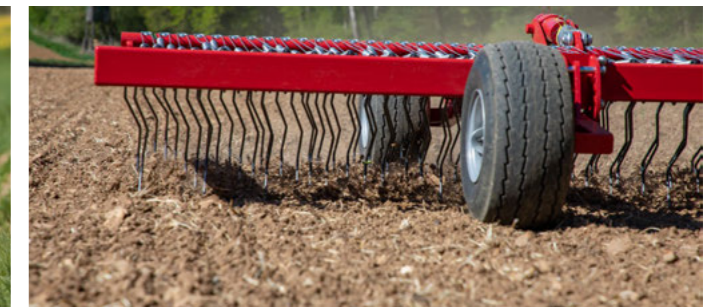
Stützräder, in einer Spur angeordnet, um z.B. in Reihenkulturen in derselben Spur zu fahren
