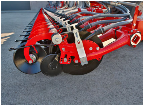
Plombage parfait des graines grâce à la roulette en caoutchouc
