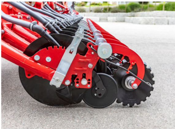
Grâce à son profil étoilé, la roulette de fermeture assure la production de terre fine et la fermeture du sillon.
