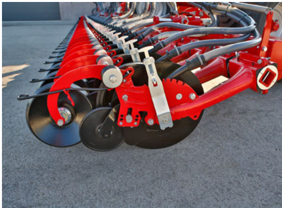
Roulette de fermeture lisse adaptée aussi aux sols déchaumés
