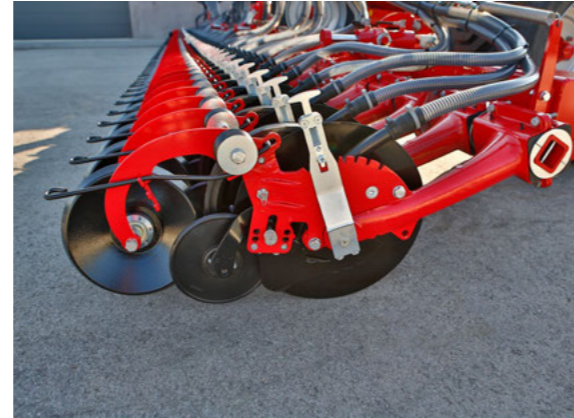
Geschlossene Schließrolle auch für bearbeitete Bedingungen
