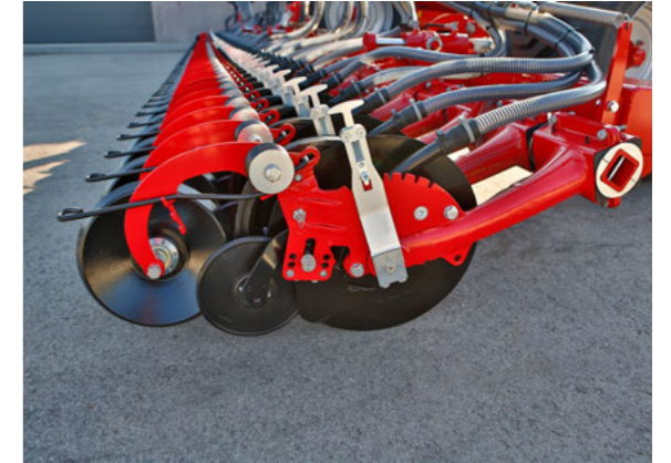
Perfekte Saatgutfixierung dank gummierter Fangrolle
