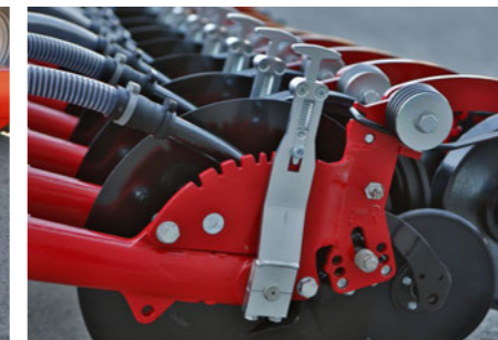
Réglage de la profondeur sans outils par cales
