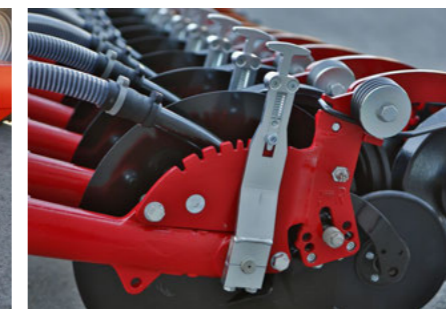
Werkzeuglose Einzeltiefenverstellung mit feiner Abstufung
