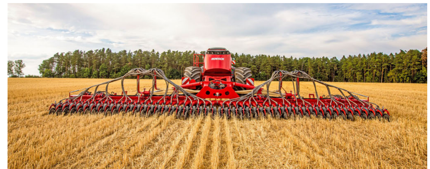
Vier Verteilertürme für selektive Verschlauchung
