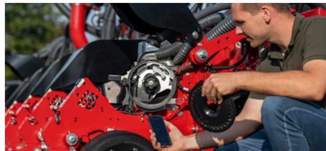
Приложение HORSCH Assist с функцией «Подбор дозирующих дисков» помогает выбрать оптимальный дозирующий диск для любой задачи
