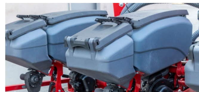
Ящики для микрогранул объемом 18 л
