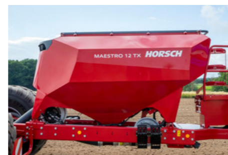
Maestro 12 TX с бункером для удобрений объемом 4 200 л
