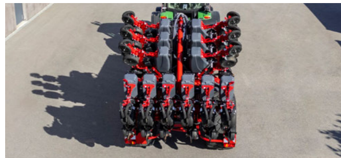
Компактные размеры в сложенном виде для движения по дорогам общего пользования
