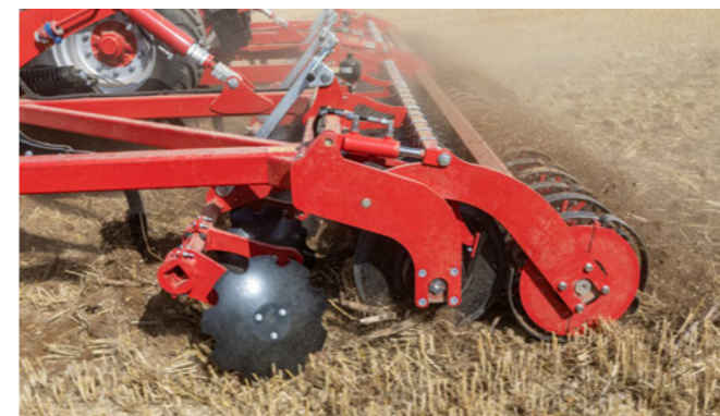
Каток с гидравлической регулировкой
