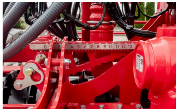
Indicador de acero inoxidable de la profundidad de trabajo de la grada rotativa – ajuste mecánico mediante llave universal
