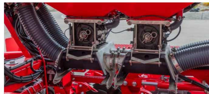
Doble tolva G&F – dosifica diferentes componentes por separado y los coloca juntos en la reja de siembra
